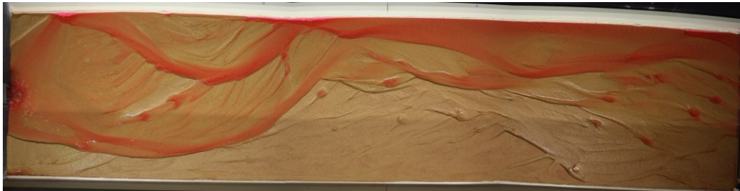
(b) Configuration de l'écoulement correspondant à une distribution bi-modale
