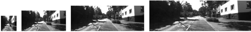
FIGURE 5.16 – Redimensionnement anisotrope : l'image à la plus basse résolution est carrée.
