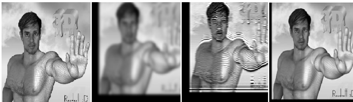
FIGURE 3.3 – Schémas décentrés ( upwind ) du premier, deuxième et troisième ordres appliqués sur l'image Roudneff jusqu'à la 200 ème itération. De gauche à droite : image originale, schéma du 1 er ordre, schéma du 2 ème ordre, schéma du 3 ème ordre.
