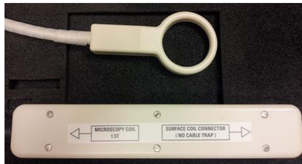
Figure 3.16. Antenne de réception circulaire utilisée pour les expériences d'imagerie du proton à 1,5 T.
