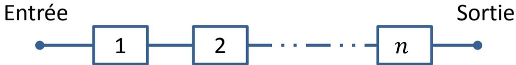
Figure 2.11: Diagramme de fiabilité d'un système série
