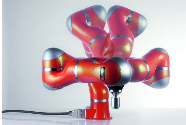
FIGURE 1.14 – Composite de quatre configurations articulaires d'un LWR4+ : un robot série a généralement plusieurs positions articulaires correspondant à une même position cartésienne. Crédits : robot : KUKA Robotics , photo : Twowheelsplus
