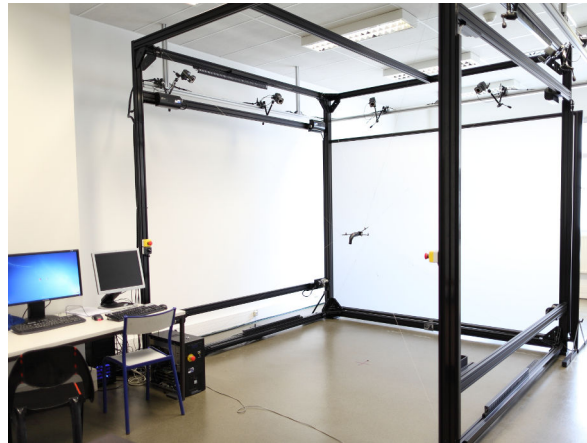
FIGURE 1.11 – Inca6D, le CDPR haptique commercial de la société Haption, installé au laboratoire ICube à Strasbourg
