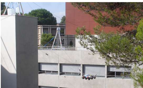
(a) Le robot MARIONET-CRANE, démontrant le secours puis transfert d'un mannequin entre les parois d'un canyon (bâtiments)
