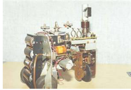
(b) Après restauration ; on notera l'alimentation par piles électriques du robot
