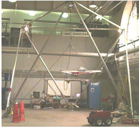
(a) Le robot SPIDER, par la suite renommé RoboCrane
