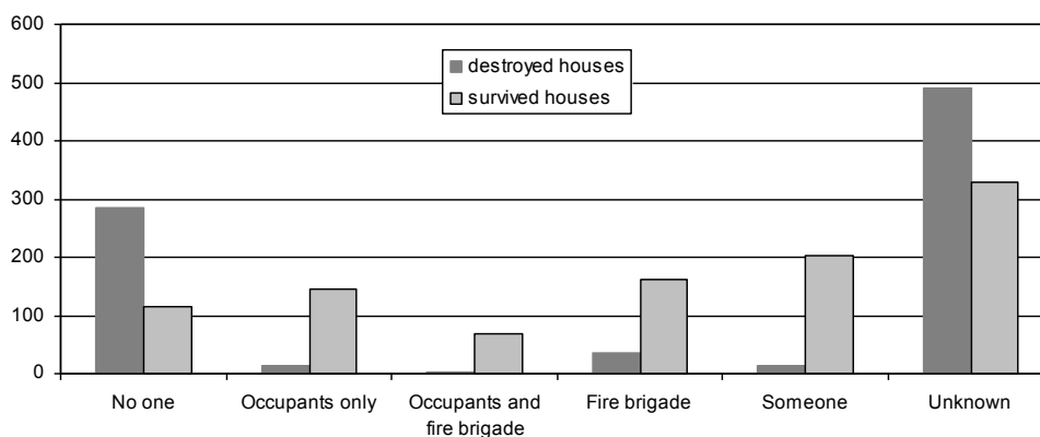
Fig. 33 : Influence des activités de luttes avant et après le passage du feu, sur les dommages occasionnés aux constructions, synthèse des trois enquêtes (Blanchi et al., 2006)
