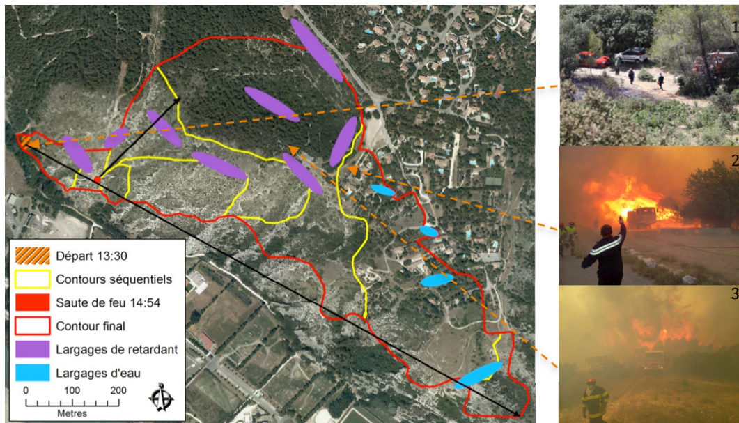
Fig. 61 : Cartographie de l'incendie de Cavaillon, illustrant le déroulement de l'incendie du départ jusqu'à l'extinction. Les axes de propagation sont représentés par les flèches noires. (Sources : SDIS Cavaillon, BD ORTHO 2010 IGN®)
