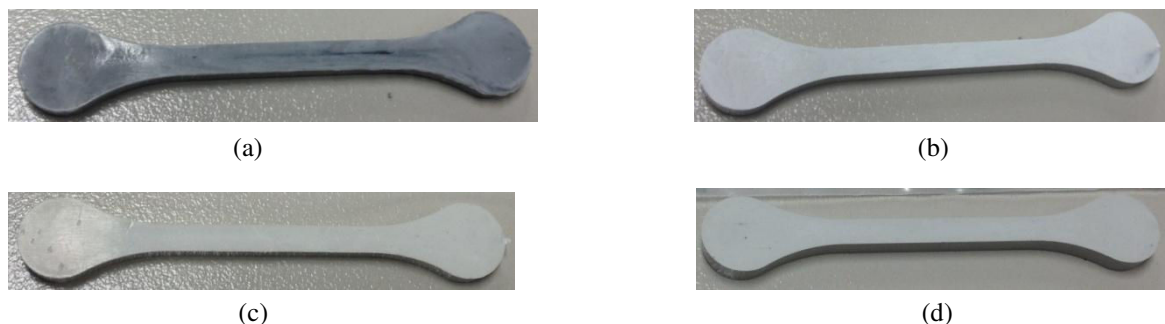
Fig. 6.3: Matériaux thermoplastiques caractérisées (a) PE avec 15% d' \text{Al}_2\text{O}_3 , (b) PE avec 30% d' \text{Al}_2\text{O}_3 , (c) PS avec 15% d' \text{Al}_2\text{O}_3 et (d) PS avec 30% d' \text{Al}_2\text{O}_3 .
