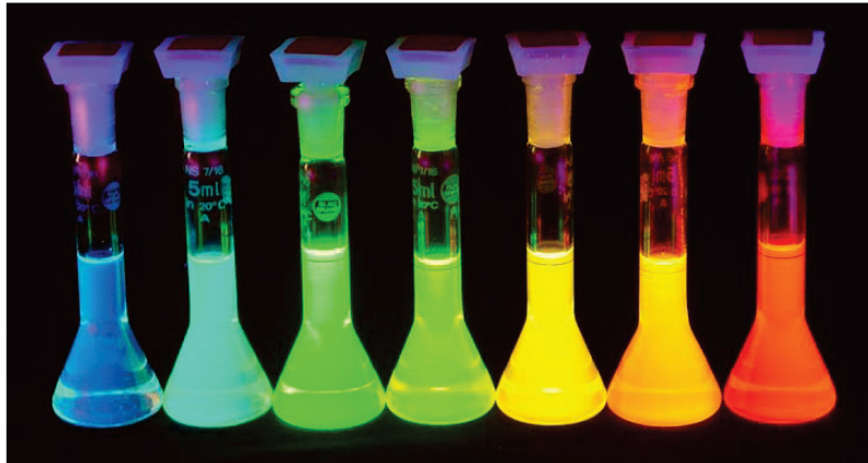
Figure 1-16. Solutions fluorescentes basées sur des Quantum Dots de différentes tailles
