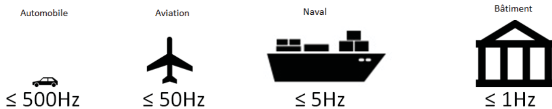
FIGURE 1 – Limite en fréquence pour l'étude de quelques cas industriels par la méthode des éléments finis. Frequency limit of investigation with finite element method for few industrial cases.
