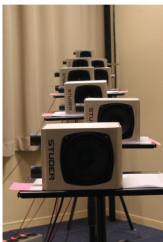
FIGURE 5.2 – Haut-parleurs placés en face des participants, à une distance allant de 1 à 5 mètres.
