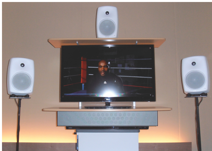
FIGURE 3.4 – Photographie représentant l'emplacement de la télévision LG (47 pouces de diagonale), la barre de son Yamaha placée sous l'écran ainsi que les trois haut-parleurs frontaux du système multicanal 5.1 Genelec utilisé.
