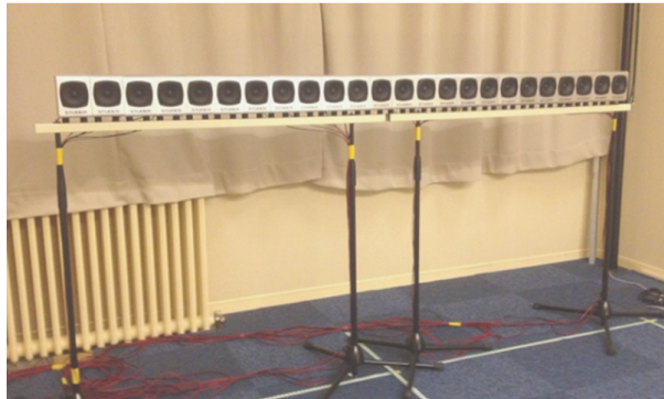
FIGURE 4.2 – Système Wave Field Synthesis composé de 24 haut-parleurs espacés de 9 cm.
