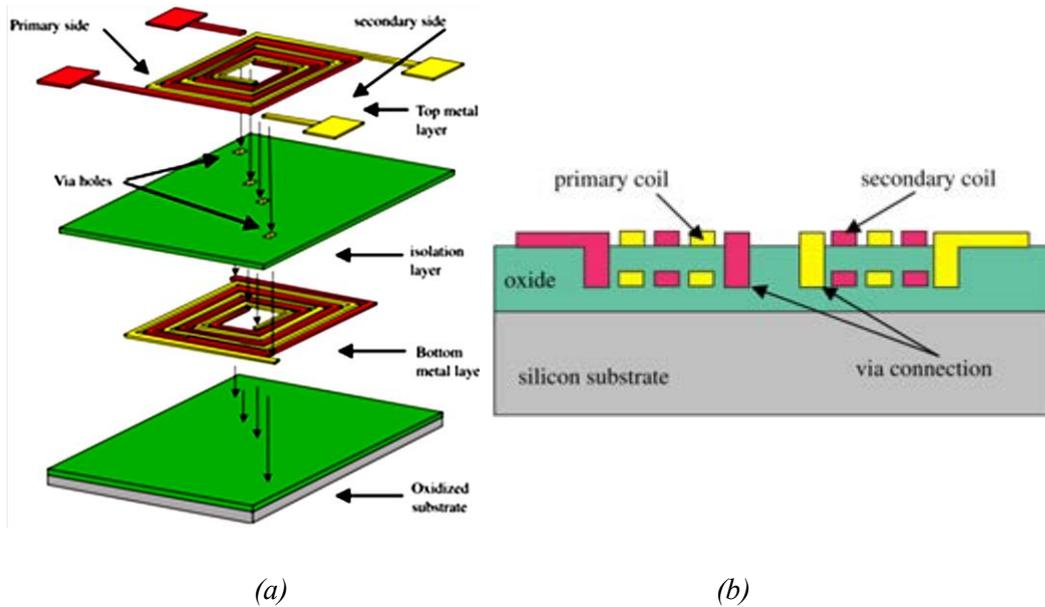
Fig.63 : Structure entrelacée à enroulements empilés [YuYe08]
