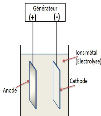
Fig.102 : Principe de l'électrolyse
