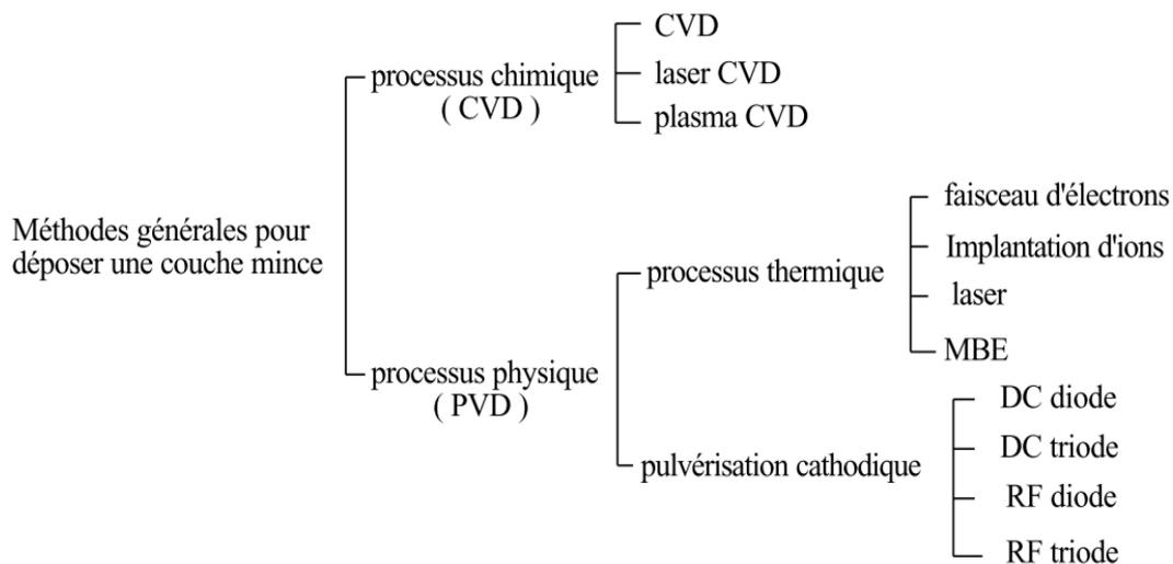
Fig.94 : Les différentes techniques de dépôt sous vide [TkMa91]
