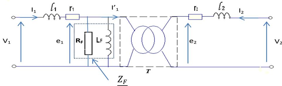
Fig.1: Modèle basse fréquence du transformateur
