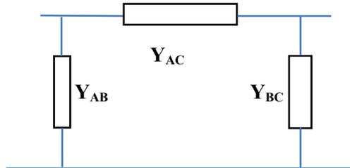
Fig.5 : Représentation simplifié du modèle HF en configuration Y
