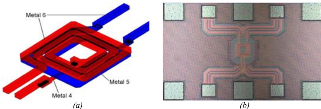
Fig.40 : Transformateur proposé par [CSJM09] (a) design du transformateur (b) photographie du transformateur
