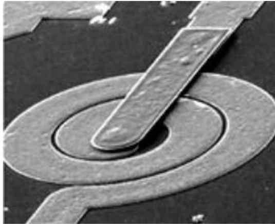
Fig.14 : Conducteur plat utilisé dans la réalisation d'une inductance [WZZD05]
