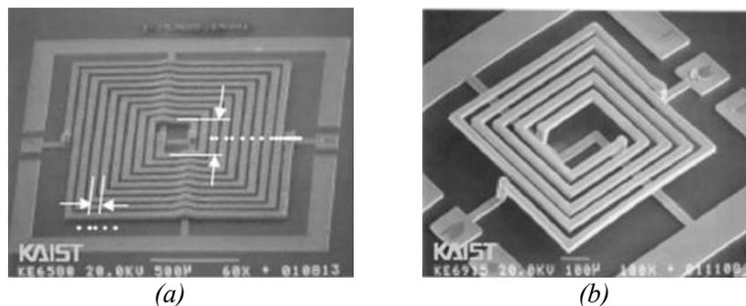
Fig.47: Transformateur proposé par [CYKY02] (a) type 1 (b) type 2
