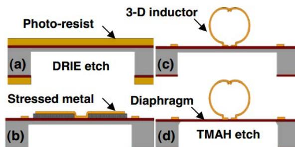
Fig.69 : Etapes de fabrication d'inductance 3D [WJKM04]
