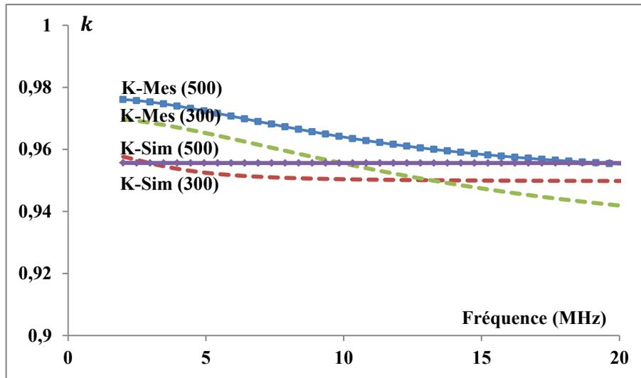
Fig.140 : Evolution du facteur de couplage en fonction de la fréquence
