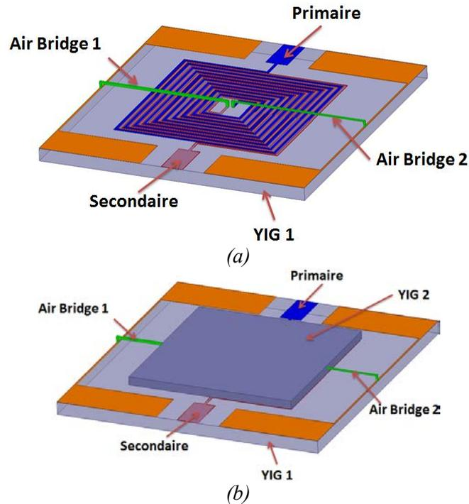
Fig.107 : Design du transformateur entrelacé avec Air Bridge :
