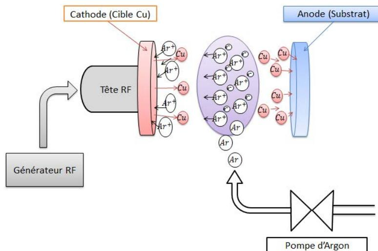
Fig.95 : Principe de la pulvérisation cathodique radiofréquence
