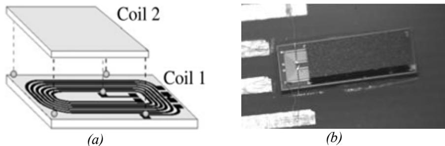
Fig.65 : (a) Schéma d'assemblage du transformateur
