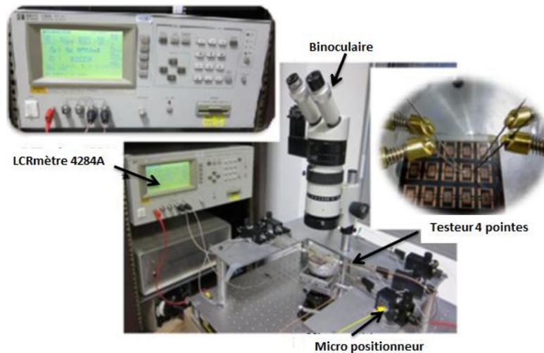
Fig.123 : LCRmètre 4284A utilisé au laboratoire LT2C [YDDa13].
