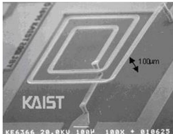
Fig.44 : Exemple d'inductance fabriquée en technologie MEMS [YKCY02]
