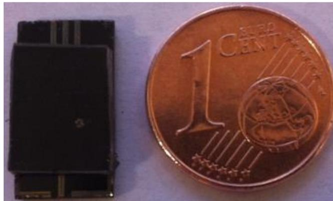
Fig.121 : Le transformateur Face-To-Face assemblé
