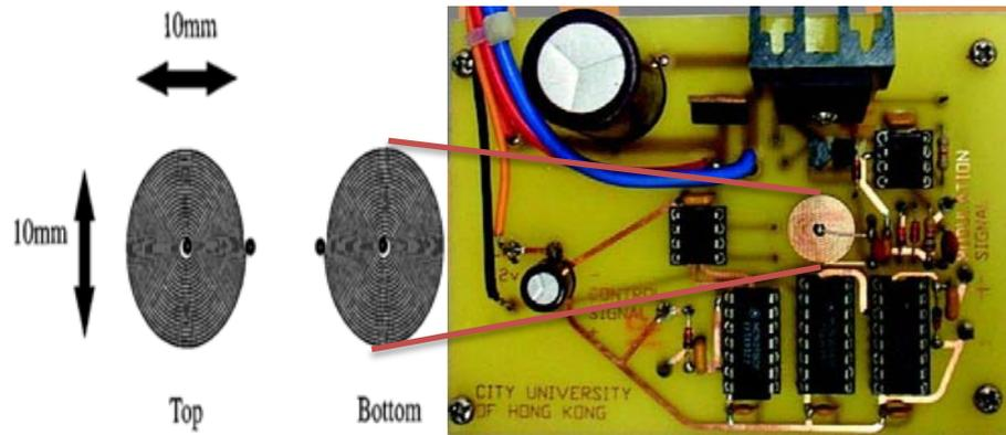
Fig.27 : Micro-transformateur PCB sans matériau magnétique [TaHC00]
