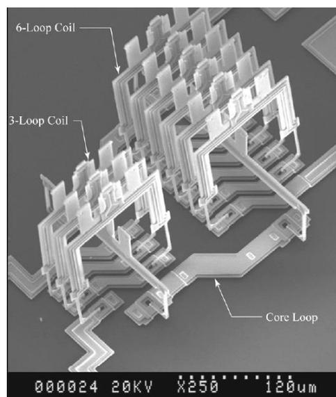
Fig.71 : Image SEM du transformateur micro assemblé [DeMC04]
