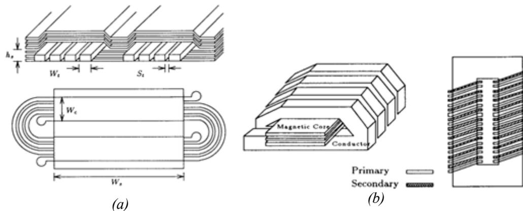
Fig.18 : Différentes structures à matériau ferromagnétique feuilleté [SuSa96]
