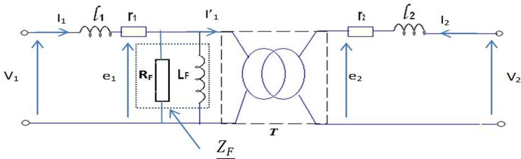
Fig.78 : Modèle basse fréquence choisie
