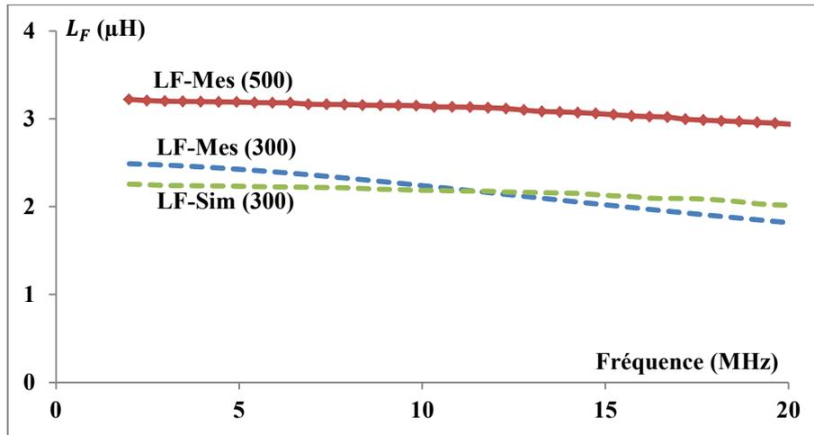
Fig.144 : Evolution de l'inductance magnétisante en fonction de la fréquence (mesure VNA)
