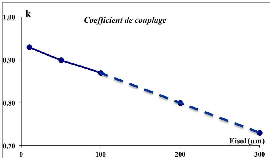
Fig.87: Influence de l'épaisseur de l'isolant sur le coefficient de couplage
