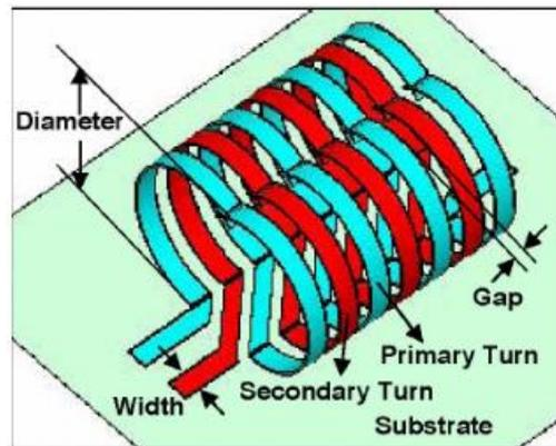
Fig.70 : Structure développée par *Dae-Hee-Weon et al.* [WJKM04]
