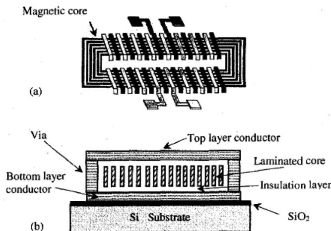
Fig.73 : Structure proposée par *Ming Xu [XLAH98]*
