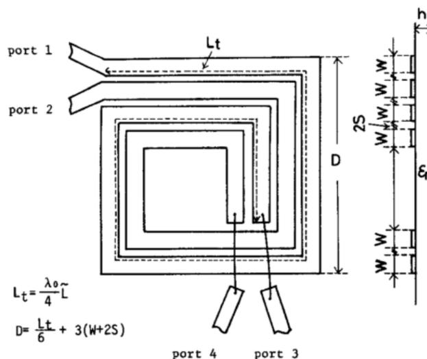
Fig.53 : Structure deux-fil-en-main présentée par Shibata [SHTK81]
