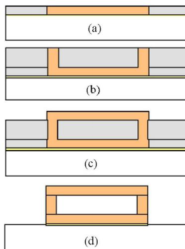
Fig.66 : Etapes de fabrication des transformateurs [PaEB02]
