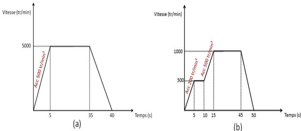
Fig.99 : Vitesse et accélération de dépôt : (a) résine SPR505 (b) résine Su-8.
