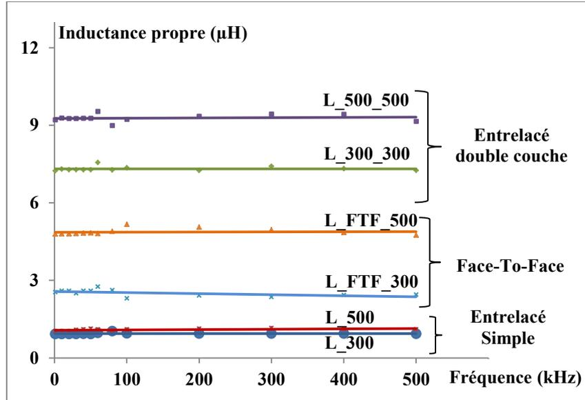
Fig.130 : Inductances propres mesurées (LCRmètre) en fonction de la fréquence
