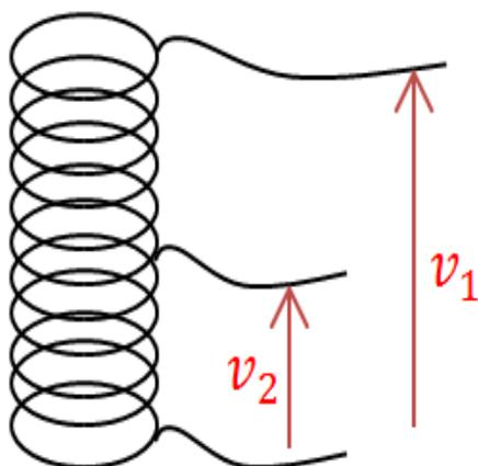
Fig.2 : Autotransformateur : le bobinage secondaire est une partie du bobinage primaire
