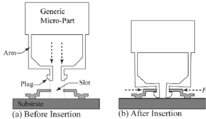
Fig.72 : Technique d'assemblage robotisé "Snap Lock Joint" [DeMC04]
