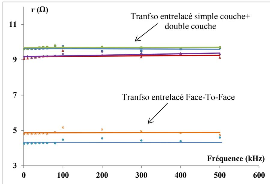
Fig. 131 : Résistance en fonction de la fréquence.
