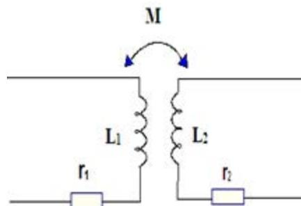
Fig.32 : Modèle simple du transformateur
