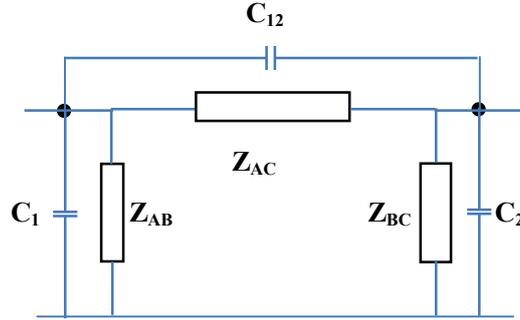
Fig.4 : Modèle HF après transformation de Kennelly
