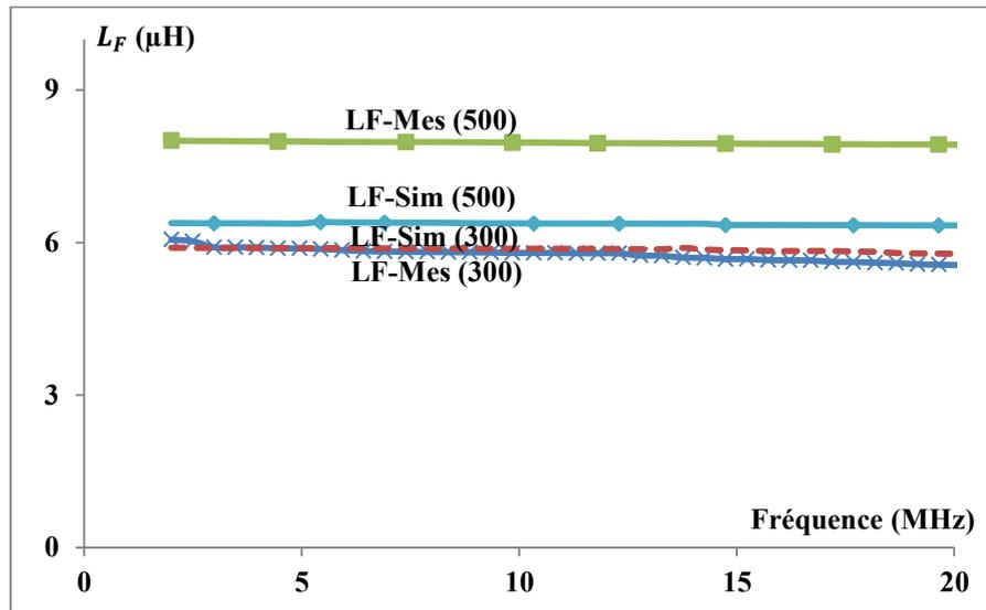
Fig.139 : Evolution de l'inductance magnétisante en fonction de la fréquence
