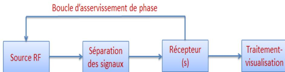
Fig.126 : Constitution d'un Analyseur de réseau [MiHi07]
