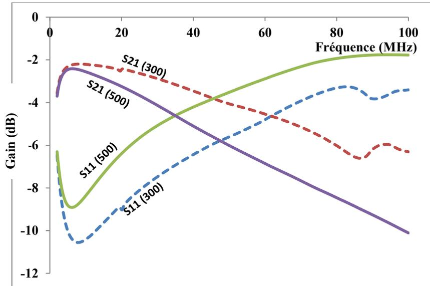
Fig.142 : Paramètres S mesurés du transformateur Face-To-Face
