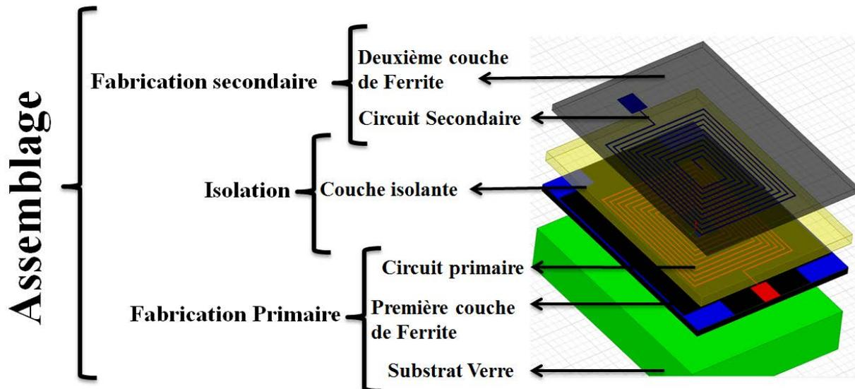
Fig.115: Etapes de fabrication du transformateur Face-To-Face
