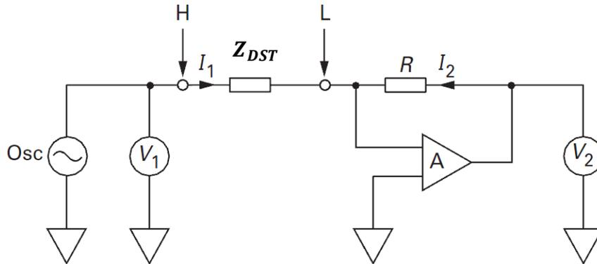
Fig.124 : Schéma du principe du Pont auto-équilibré [AgTe06]
