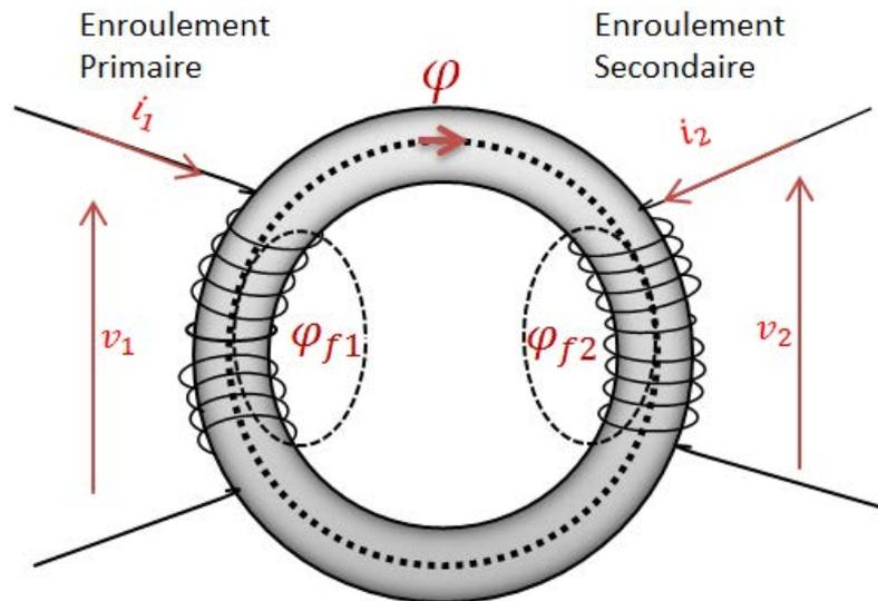
Fig.5 : Illustration des fuites dans le transformateur
