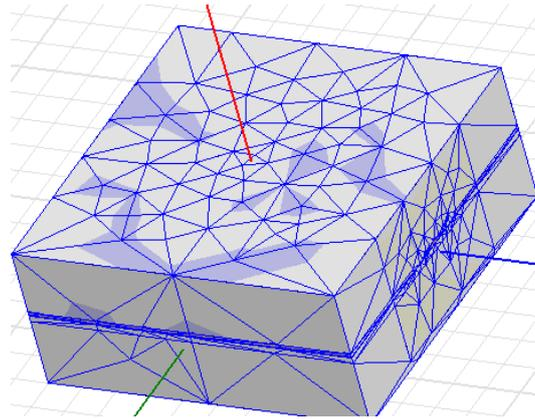
Fig.75 : Maillage d'une structure sous HFSS.
