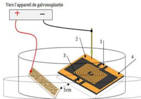
Fig.104 : Dorure d'une inductance par électrolyse [YDDa13]
