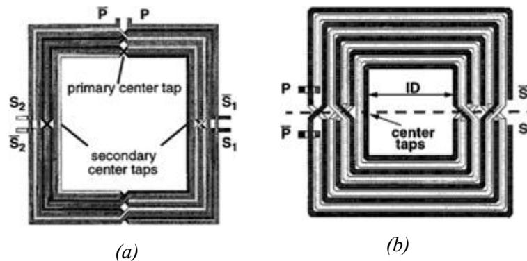
Fig.55 : Structure entrelacée [Long00] Structure symétrique [GGRa91]
