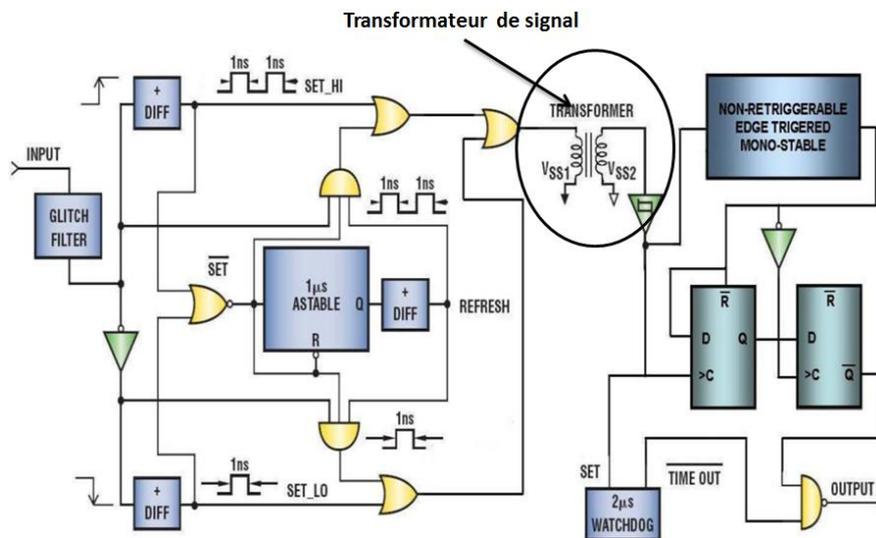
Fig.30 : Schéma du demi-pont proposé par [Chen08]
