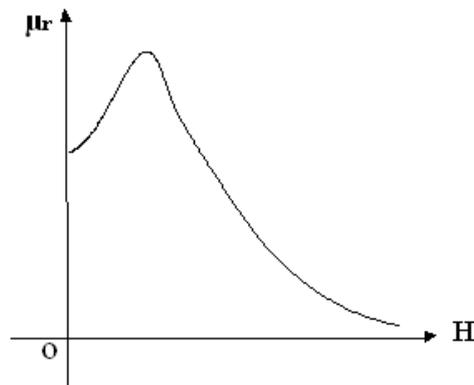
Fig.11 : Perméabilité magnétique relative d'un matériau magnétique
