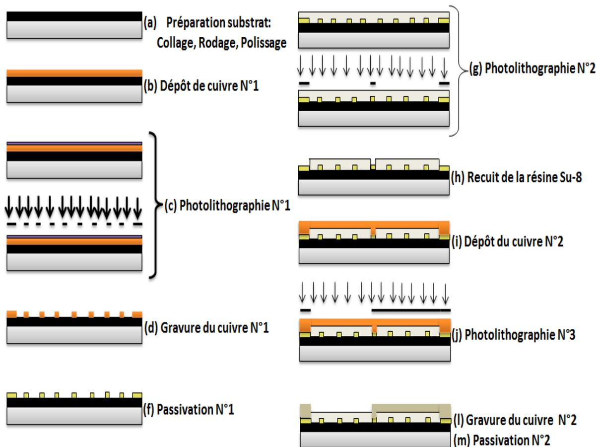
Fig.117 : Flowchart de la fabrication du circuit primaire/secondaire
