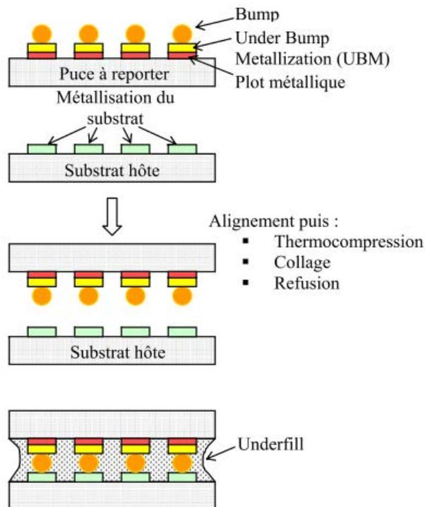
Fig.118 : Technique d'assemblage par flip-chip [DaPe06]
