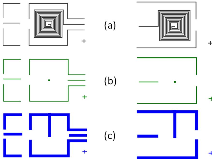
Fig.116 : Masque de photolithographie du transformateur Face-To-Face
