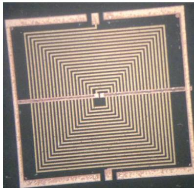
Fig.110 : Photographie du transformateur entrelacé avec "Air Bridge".
