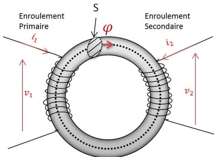
Fig.4 : Transformateur bobiné autour d'un noyau torique
