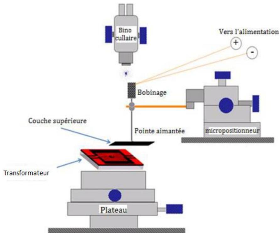
Fig.112 : Micromanipulateur de positionnement des couches supérieures [YDDa13]
