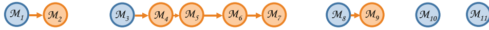
FIGURE 1.4 – Représentation sous forme de graphes orientés d'une séquence de maillages. La distance entre les sommets correspond au coût du codage d'une transformation.
