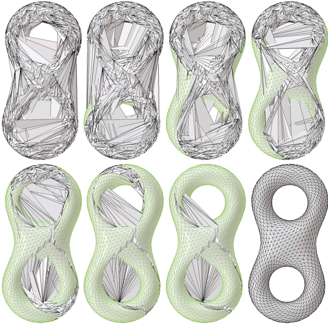
FIGURE 3.27 – L'algorithme appliqué à une surface de genre 2. Le cas ( SD ) est utilisé au moment où la région non conforme correspond à l'union de plusieurs cycles d'arêtes.
