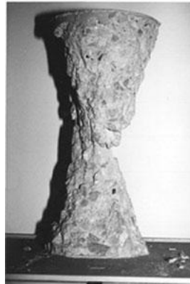
Figure 3 – Forme finale de l'éprouvette lors d'un essai de compression.
