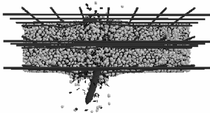
Figure 90 – Simulation d'une dalle en béton armé soumise à un impact (Cusatis et Pelessone, 2006).
