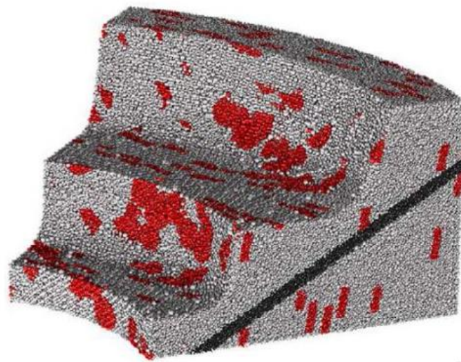
Figure 37 - Maillage éléments discrets d'une partie d'une mine à ciel ouvert (Jerier et al., 2009).
