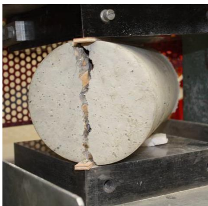
Figure 8 - Faciès de fissuration de l'éprouvette par essai de fendage.
