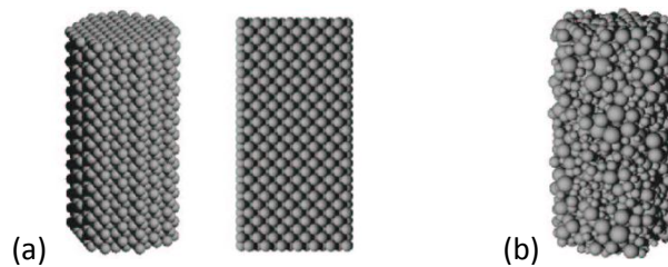
Figure 33 – Exemples de maillages ED ordonnés (a) et désordonné (b) (Hentz, 2003).
