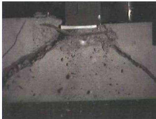
Figure 201 – Endommagement de la poutre n°3 dans l'essai.
