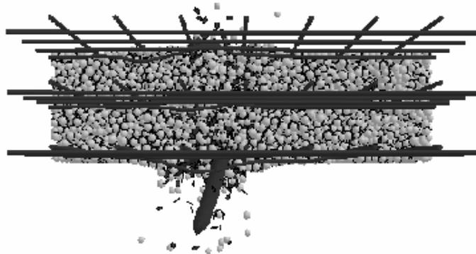
Figure 90 – Simulation d'une dalle en béton armé soumise à un impact (Cusatis et Pelessone, 2006).
