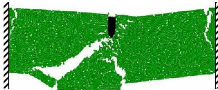
Figure 30 - Simulation d'une poutre en béton soumise à un impact (Tavarez, 2005).
