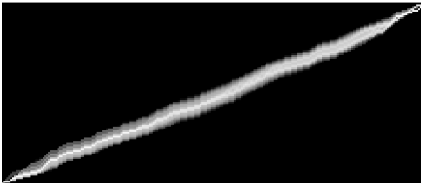
FIG. 3.1 – Probabilités des états sur le treillis bit/symbole pour le code C_{10} et E_b/N_0 = 0 dB.
