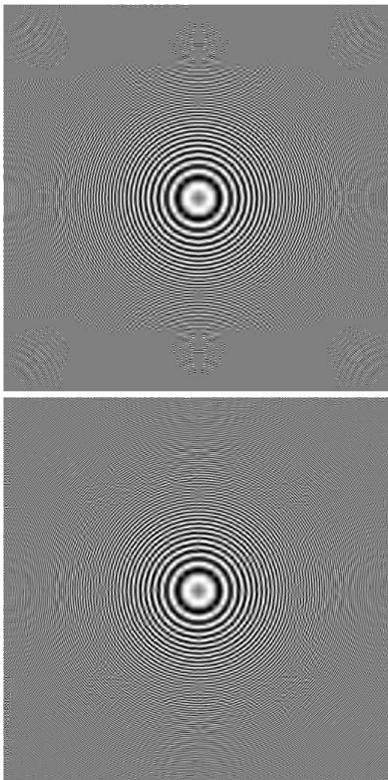
FIG. 3.17: [haut] Codage par EZBC d'une transformée en ondelettes séparable 9/7 sur 5 niveaux de l'image *zoneplate* à 0.25 bpp, PSNR = 11.64 dB. [bas] Codage par transformée hybride et EZBC sur 5 niveaux de l'image *zoneplate* à 0.20bpp, PSNR = 13.86 dB.
