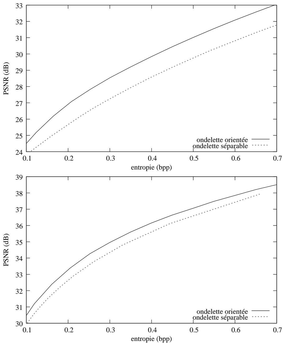
FIG. 4.18: Performance débit-distorsion en utilisant l'estimateur de débit par entropie absolue pour les images *barbara* [haut] et *lena* [bas] codées avec 5 niveaux d'ondelettes séparables et 10 niveaux d'ondelettes orientées respectivement.
