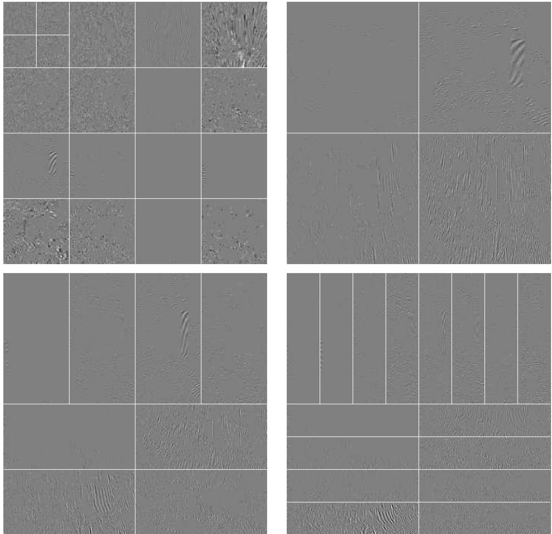
FIG. 3.22: Coefficients conservés après décodage par 3D-ESCOT dans les sous-bandes du schéma par ondelettes [haut gauche] et les sous-bandes directionnelles du schéma par contourlettes avec 4 [haut droit], 8 [bas gauche] et 16 [bas droit] directions d'analyse pour un débit cible de 192kbit/s. Dans sa configuration originale, le schéma vidéo par ondelettes effectue une décomposition supplémentaire dans les bandes de plus hautes fréquences, menant à une structure d'analyse en paquets d'ondelettes.
