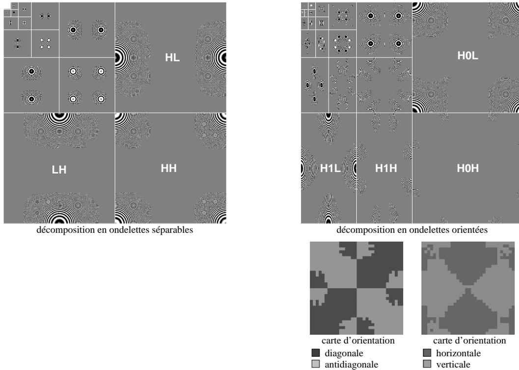
FIG. 4.5: Coefficients conservés par EBCOT pour une décomposition en ondelettes séparables [gauche] et orientées [droite] de l'image *zoneplate* pour un débit cible de 0.5 bpp. Les PSNR des images reconstruites correspondantes sont respectivement de 19.2 dB et 20.6 dB. Les cartes d'orientations correspondantes pour la transformée en ondelettes orientées sont également représentées.
