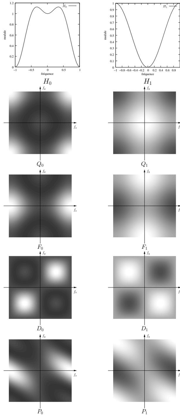
FIG. 3.7: Exemples de paires de filtres quinconce ( $Q_0, Q_1$ ), éventail ( $F_0, F_1$ ), damier ( $D_0, D_1$ ) et parallélogramme ( $P_0, P_1$ ) issus de la paire de filtres  $5/3$  ( $H_0, H_1$ ). La réponse fréquentielle des filtres 2D est représentée par des intensités variant du blanc (module = 0) au noir (module = 2).
