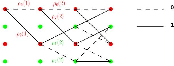
FIG. 5.3: Métriques de branches correspondant à la distorsion.
