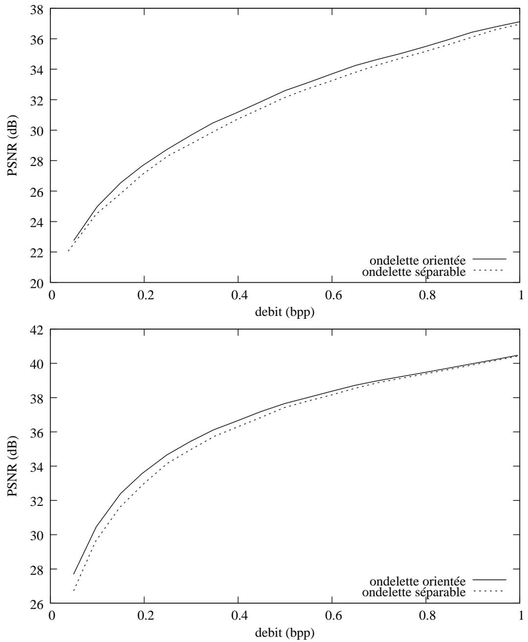
FIG. 4.19: Performance débit-distorsion en utilisant EBCOT pour les images *barbara* [haut] et *lena* [bas] codées avec 5 niveaux d'ondelettes séparables et 10 niveaux d'ondelettes orientées respectivement.
