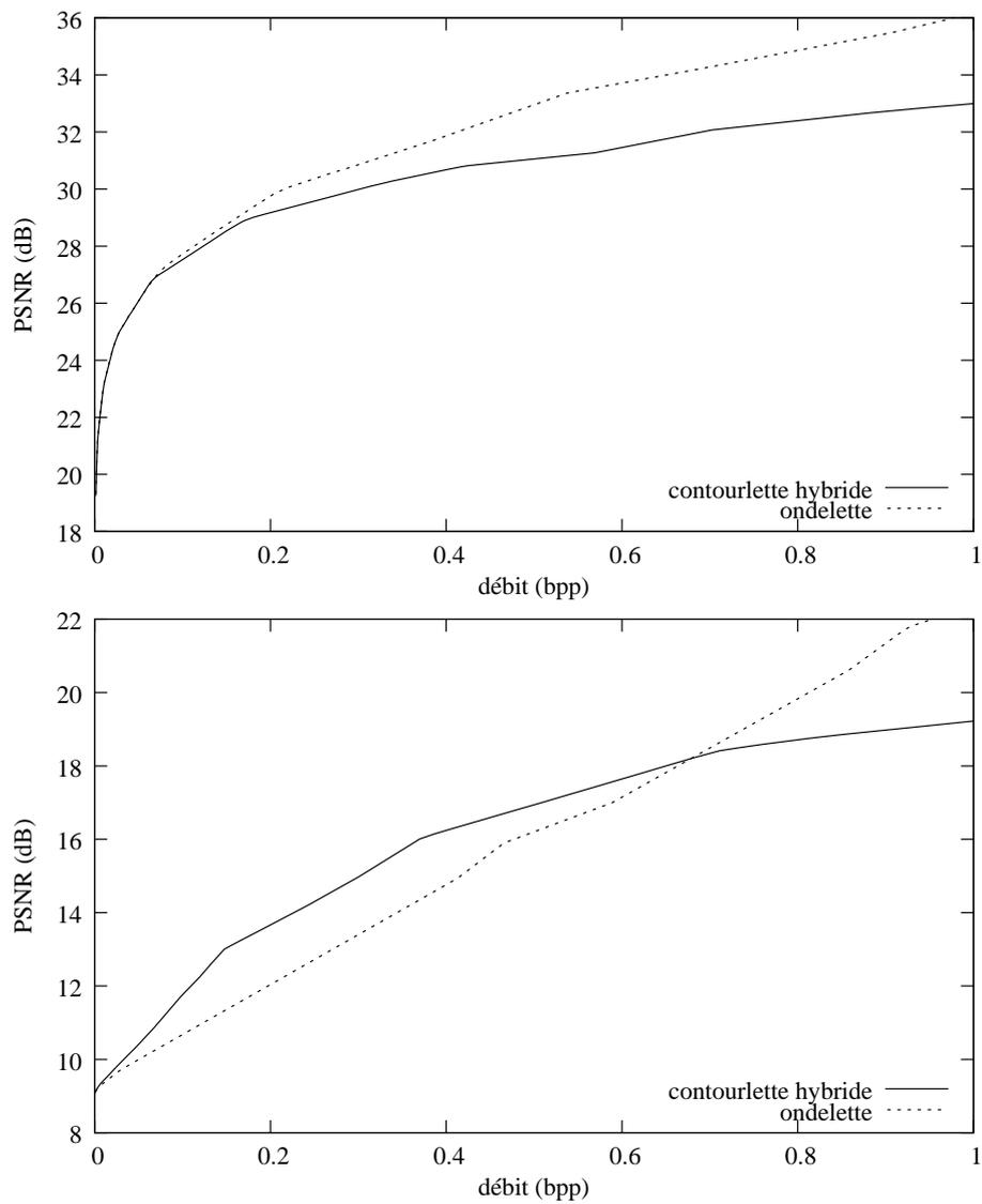
FIG. 3.15: Performance débit-distorsion de la transformée hybride et de la transformée en ondelettes sur 5 niveaux pour les images *goldhill* [haut] et *zoneplate* [bas]. La transformée hybride utilise une analyse sur 16 et 8 directions respectivement pour le premier et le second niveau. Les niveaux suivants sont décomposés en ondelettes séparables.
