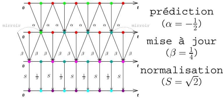
FIG. 1.13: Implémentation lifting d'un banc de filtres 5/3.
