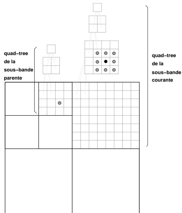
FIG. 2.9: Contexte pour le codage de la signifiante des noeuds dans EZBC. Le noeud courant est représenté en noir et son contexte intra et inter sous-bande en gris.
