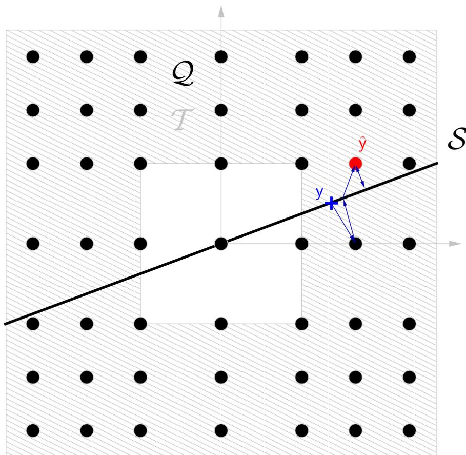
FIG. 3.12: Illustration du principe de projections sur espaces convexes pour la quantification des contourlettes. L'ensemble  $\mathcal{S}$  est représenté par une droite (de dimension inférieure au plan) sur laquelle se trouve le vecteur  $y$  initial. Après plusieurs projections, l'algorithme converge et le centroïde retenu n'est pas forcément le plus proche de  $y$  dans l'absolu.
