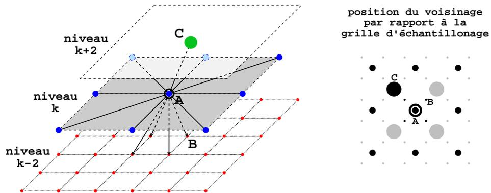
FIG. 4.24: Voisinage considéré dans le champ de Markov. La figure 3D représente l'ensemble des voisins du noeud central (A) au niveau *k* en lignes épaisses. La figure 2D indique en noir la position spatiale de ce même voisinage dans  $\mathbb{Z}^2$ . Les points les plus petits correspondent aux échelles fines. Le noeud (B) est fils de (A), tandis que le noeud (C) est père de (A).
