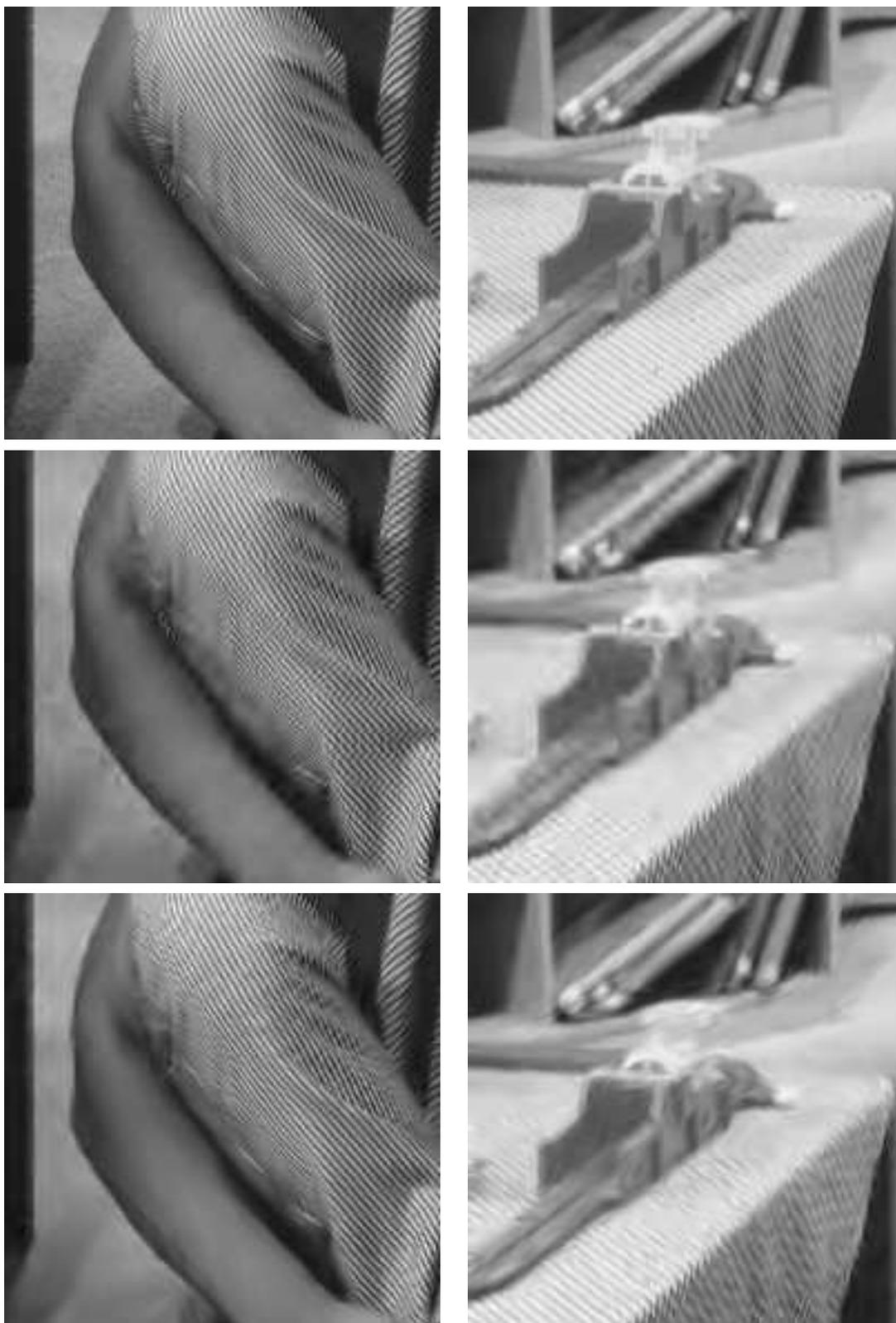
FIG. 4.10: Détails de l'image *barbara* originale [haut], analysée par ondelettes séparables [milieu] et par ondelettes orientées [bas], puis codée à 0.3 bpp par le codeur EBCOT. Les contours sont mieux préservés par les ondelettes orientées et l'effet de rebond est limité.
