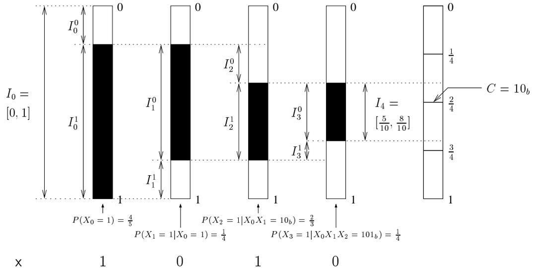
FIG. 1.14: Codeur arithmétique. L'intervalle  $[0, 1]$  est subdivisé successivement en fonction de la probabilité d'apparition de chaque symbole. Le mot de code  $C$  représentant la séquence est le numérateur d'une fraction appartenant à l'intervalle final. Le décodage s'effectue en testant l'appartenance de ce point aux intervalles des symboles.
