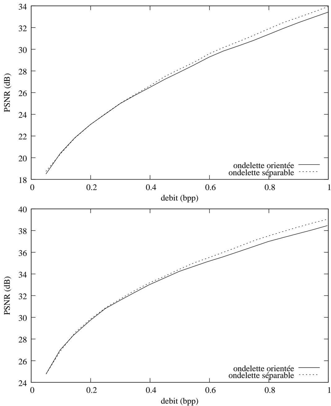
FIG. 4.20: Performance débit-distorsion en utilisant EBCOT pour les images *bike* [haut] et *boat* [bas] codées avec 5 niveaux d'ondelettes séparables et 10 niveaux d'ondelettes orientées respectivement.
