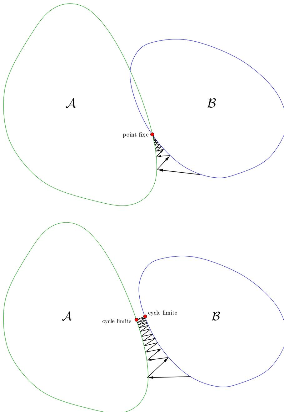
FIG. 3.11: Projections sur espaces convexes. [haut] Cas d'ensembles d'intersection non vide. L'algorithme converge vers un point fixe. [bas] Cas d'ensembles disjoints. L'algorithme entre dans un cycle limite.
