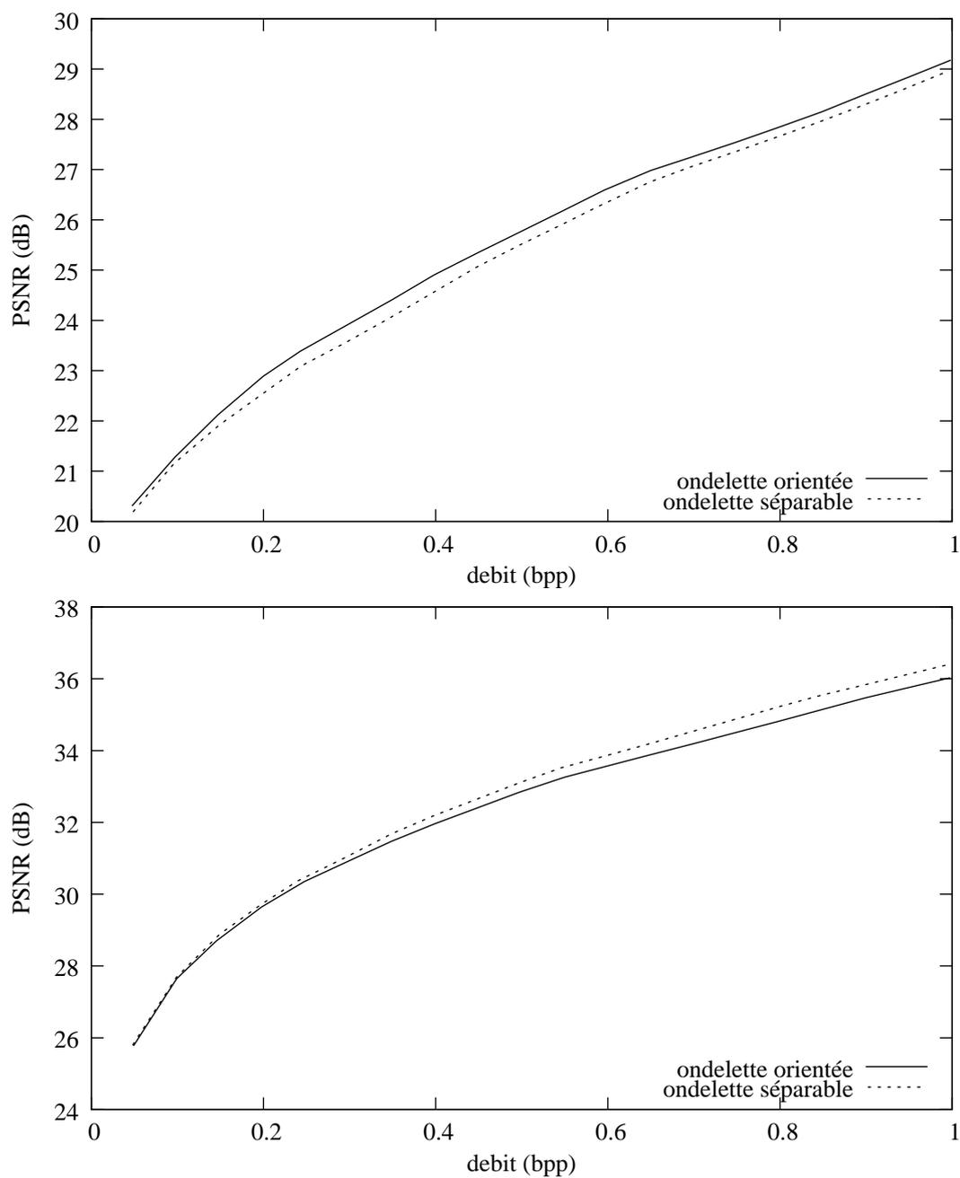
FIG. 4.21: Performance débit-distorsion en utilisant EBCOT pour les images *mandrill* [haut] et *goldhill* [bas] codées avec 5 niveaux d'ondelettes séparables et 10 niveaux d'ondelettes orientées respectivement.
