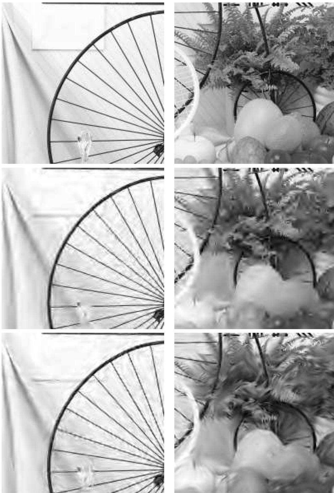
FIG. 4.12: Détails de l'image *bike* originale [haut], analysée par ondelettes séparables [milieu] et par ondelettes orientées [bas], puis codée à 0.3 bpp par le codeur EBCOT. Les textures apparaissent moins pixélisées avec les ondelettes orientées.
