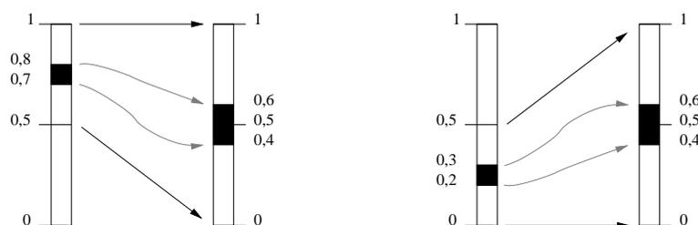
FIG. 1.15: Renormalisation de l'intervalle du codeur arithmétique. Le mot de code  $C$  commence par 0; ce bit est envoyé et l'intervalle  $[0, \frac{1}{2}]$  est renormalisé en  $[0, 1]$  [gauche]. Renormalisation lorsque le mot de code  $C$  commence par 1 [droite].
