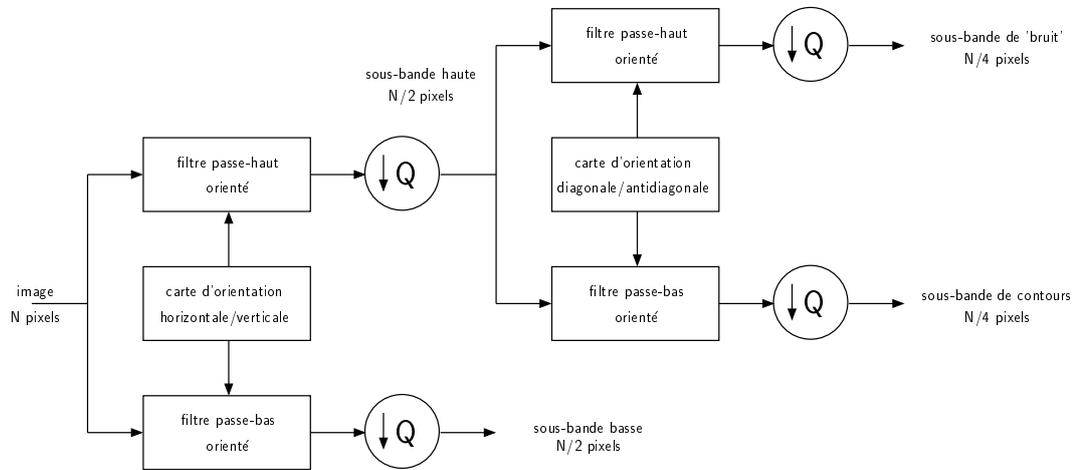
FIG. 4.4: Un niveau de décomposition en sous-bandes orientées. L'image d'origine est séparée en une sous-bande de basse fréquence et une sous-bande de haute fréquence à l'aide d'une carte d'orientation. Cette décomposition est itérée sur la sous-bande basse, tandis que la sous-bande haute est à nouveau décomposée en une sous-bande de contours et une sous-bande de bruit d'après la carte d'orientation complémentaire.
