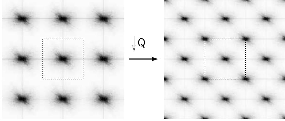
FIG. 1.3: Repliement du spectre de l'image *lena* [3] dû au ré-échantillonnage sur grille quinconce. La zone en pointillé représente la zone du spectre considérée par la transformée de Fourier discrète.
