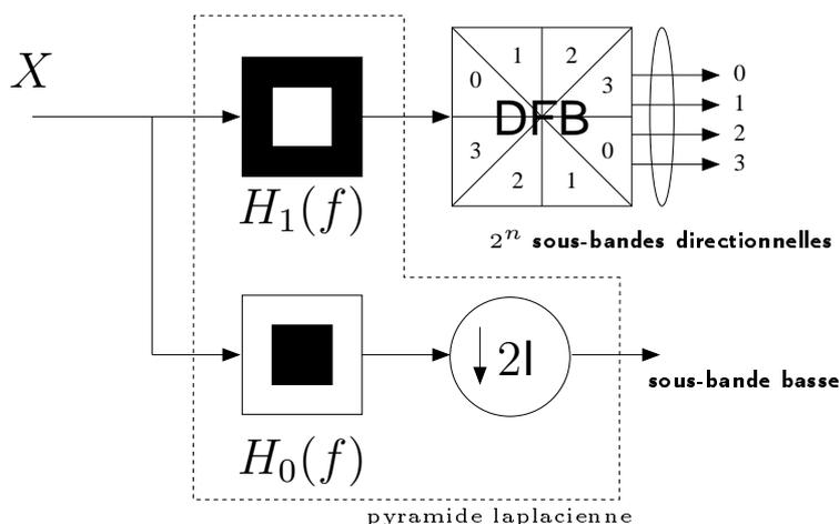
FIG. 3.1: Un niveau d'analyse la tranformée en contourlette. Les régions noires indiquent la réponse fréquentielle idéale du filtre. La sous-bande de haute fréquence obtenue après filtrage par  $H_1$  n'est pas sous-échantillonnée.
