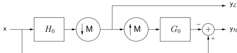
FIG. 3.2: Étape d'analyse de la pyramide laplacienne.
