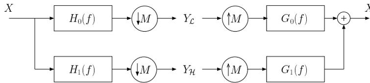
FIG. 1.6: Banc de filtres d'ondelettes à deux canaux.
