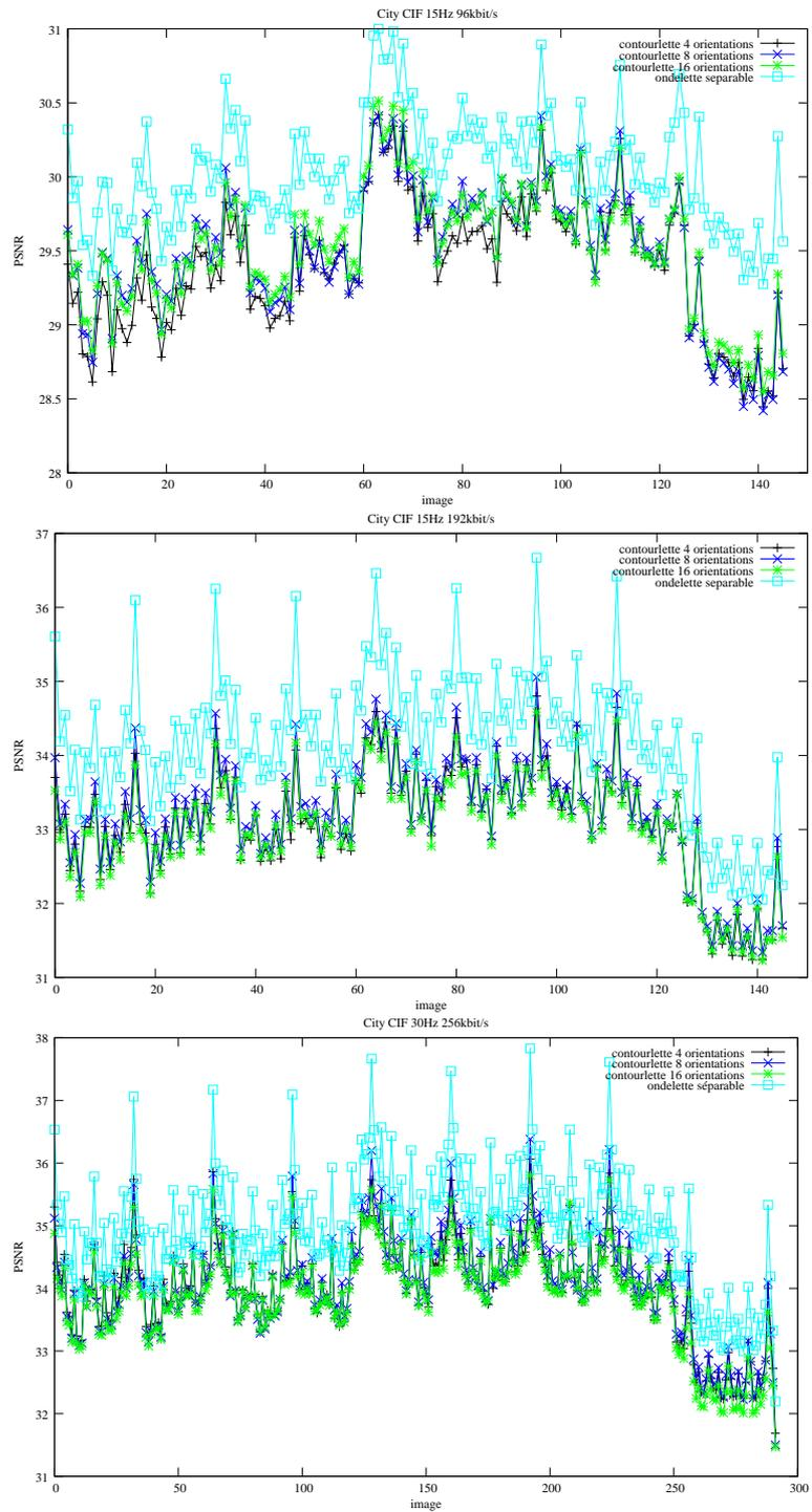
FIG. 3.20: Valeurs de PSNR obtenues sur la composante de luminance de la séquence City pour le schéma de codage vidéo par ondelettes et le schéma de codage vidéo par contourlettes à différents débits et différents nombres d'orientations.
