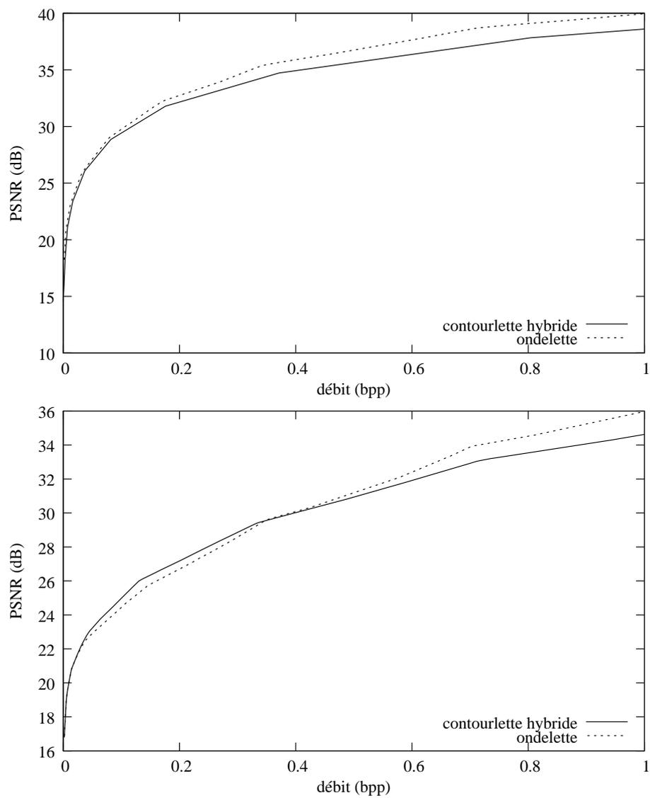
FIG. 3.14: Performance débit-distorsion de la transformée hybride et de la transformée en ondelettes sur 5 niveaux pour les images *lena* [haut] et *barbara* [bas]. La transformée hybride utilise une analyse sur 16 et 8 directions respectivement pour le premier et le second niveau. Les niveaux suivants sont décomposés en ondelettes séparables.
