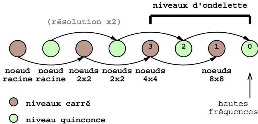
FIG. 4.6: Dépendance inter-échelle des quad-trees pour une décomposition sur 8 niveaux d'une image 16x16.
