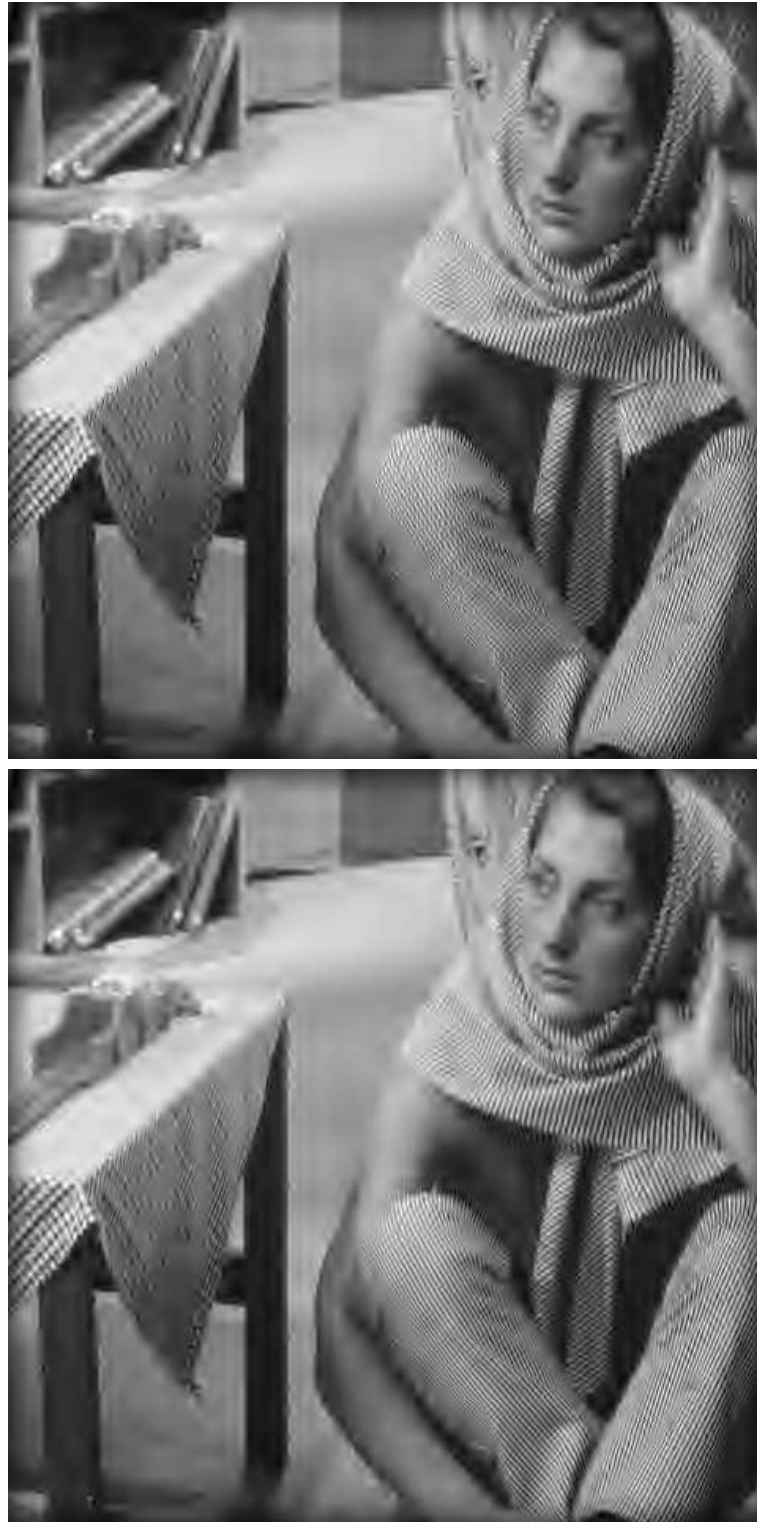
FIG. 3.16: [haut] Transformée en ondelettes séparable 9/7 sur 4 niveaux de l'image barbara . Pour une entropie des coefficients quantifiés des sous-bandes de hautes fréquences égale à 0.2 bpp, le PSNR vaut 26.62 dB. [bas] Transformée hybride sur 4 niveaux de l'image barbara . Pour une entropie des coefficients quantifiés des sous-bandes de hautes fréquences égale à 0.2bpp, le PSNR vaut 27.57 dB. La sous-bande de basse fréquence est identique pour les deux transformées et codée parfaitement.
