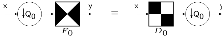
FIG. 3.4: Transformation des filtres en éventail en filtres en damier. La paire de filtres en éventail ( F_0, F_1 ) devient une paire de filtres en damier ( D_0, D_1 ) après inversion du filtrage et du sous-échantillonnage par Q_0 .
