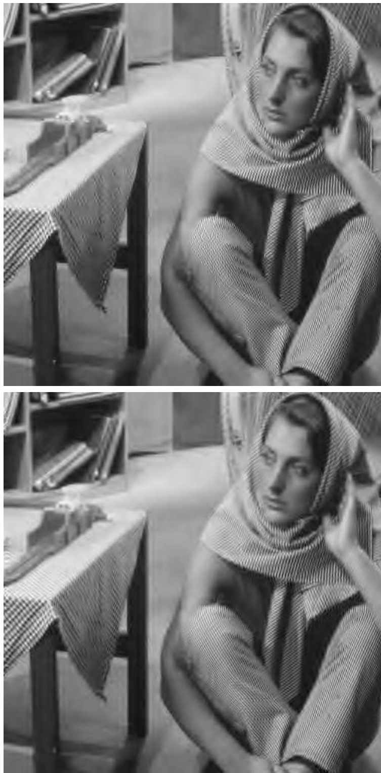
FIG. 3.18: [haut] Codage par EZBC d'une transformée en ondelettes séparable 9/7 sur 5 niveaux de l'image barbara à 0.20 bpp, PSNR = 26.59 dB. [bas] Codage par transformée hybride et EZBC sur 5 niveaux de l'image barbara à 0.20bpp, PSNR = 26.99 dB.
