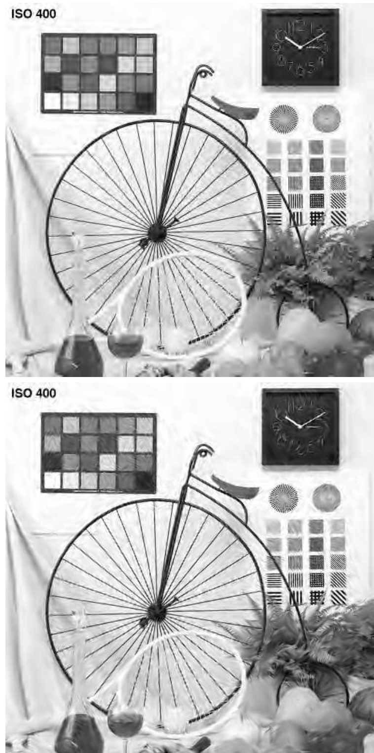
FIG. 4.11: [haut] Image bike 512x512 codée en utilisant 5 niveaux de décomposition d'ondelettes 9/7 séparables et le codeur EBCOT à 0.3 bpp, PSNR = 25.14 dB. [bas] Même image codée en utilisant 10 niveaux d'ondelettes 9/7 orientées et le codeur EBCOT à 0.3 bpp, PSNR = 25.00 dB.
