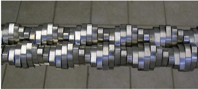
Figure 35. Bloc d'éléments malaxeurs décalés à  $+25,7^\circ$  (photo prise au CVG)
