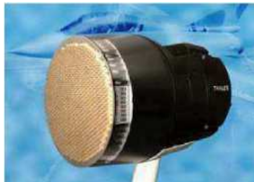
Figure II-1 : Exemple d'antenne active AESA en bande X (Radar RBE2 pour Rafale) [49]
