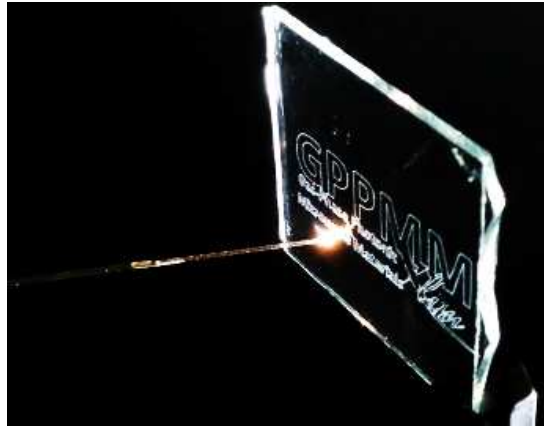
Figure 1.26 : Exemple d'application par un transport de puissance dans les fibres Kagome pour des applications de micro-gravure sur une feuille de verre à 1 \mu\text{m} [Debord(2014)].
