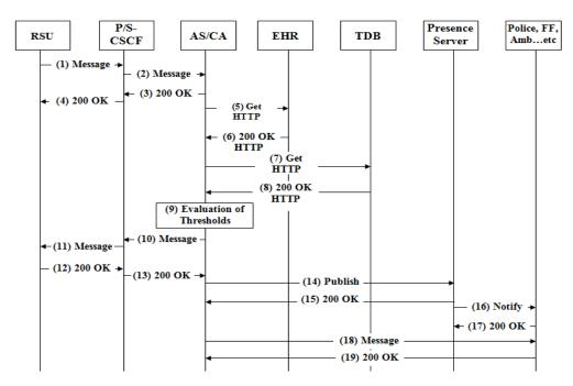
Figure C.8: Flux de signalisation de demande dans l'IMS
