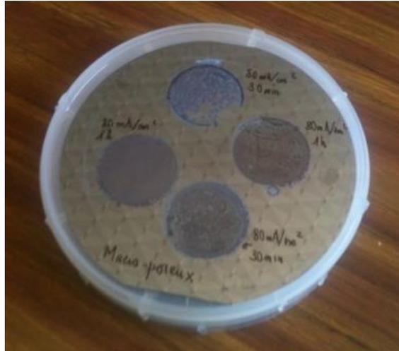
**Figure 58 : Différents spots de silicium macroporeux sur un wafer réalisés à l'Institut de Microtechnologie de Neuchâtel avec un wafer de silicium de type n**
