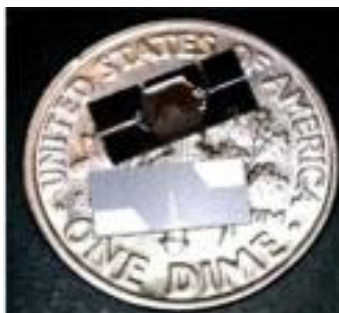
Figure 30 : Préconcentrateur microfabriqué pour l'analyse du 2,4-DNT développé par Zellers et al. [Serrano, 2013]
