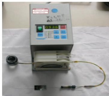
Figure 118 : Appareil de dépôt par voie fluïdique réalisé à l'aide d'une pompe péristaltique [Camara, 2009]
