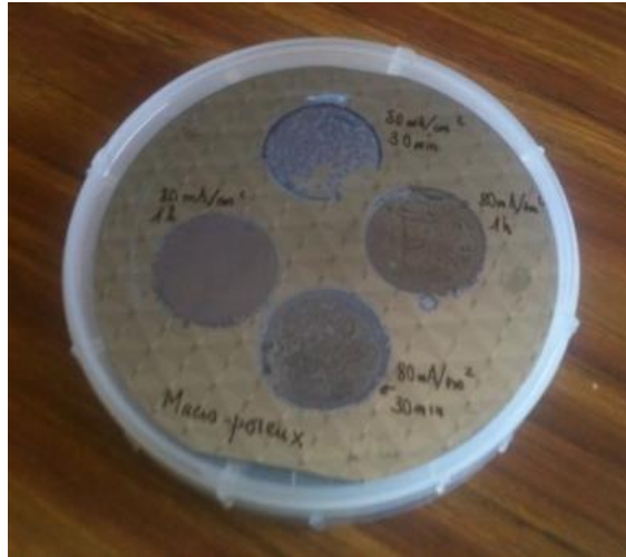
Figure 58 : Différents spots de silicium macroporeux sur un wafer réalisés à l'Institut de Microtechnologie de Neuchâtel avec un wafer de silicium de type n
