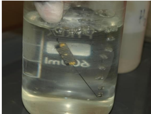
Figure 108 : Test d'étanchéité en plongeant le préconcentrateur alimenté en gaz dans un récipient d'eau
