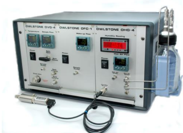
Figure 129 : Générateur de vapeur [Owlstone, 2008]
