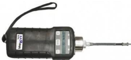
**Figure 139 : Détecteur PID**
