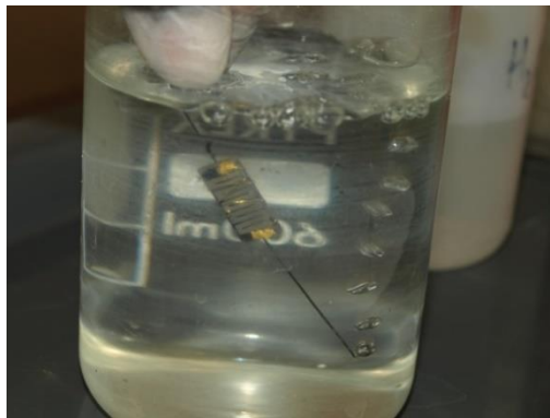
Figure 108 : Test d'étanchéité en plongeant le préconcentrateur alimenté en gaz dans un récipient d'eau
