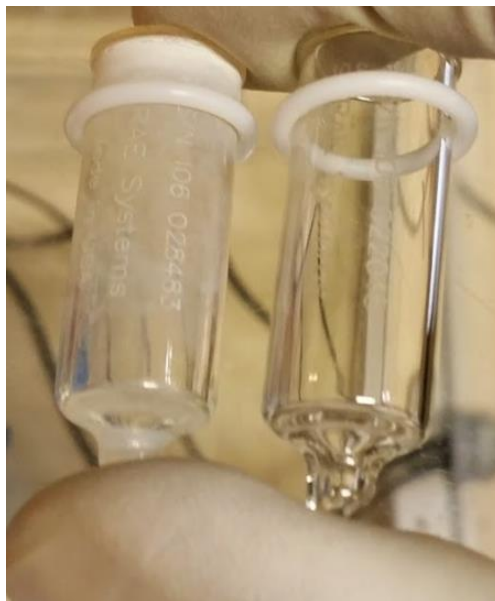
Figure 141 : Comparaison entre une lampe « encrassée » suite à l'adsorption de DNT et une lampe « propre »
