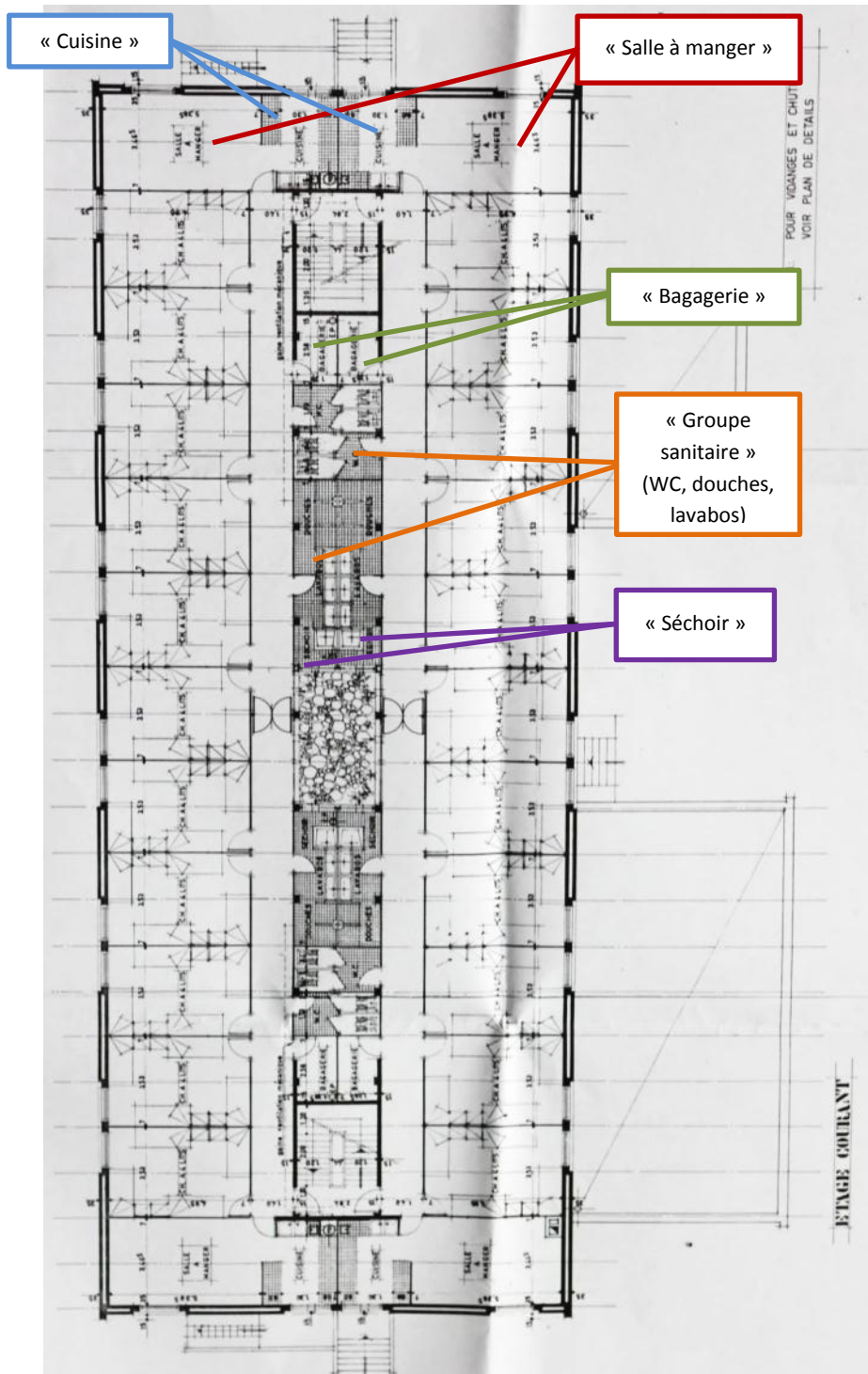
FIGURE 6.4 – PLAN D'UN ETAGE COURANT DU FOYER A SELON LE PERMIS DE CONSTRUIRE DE 1971
