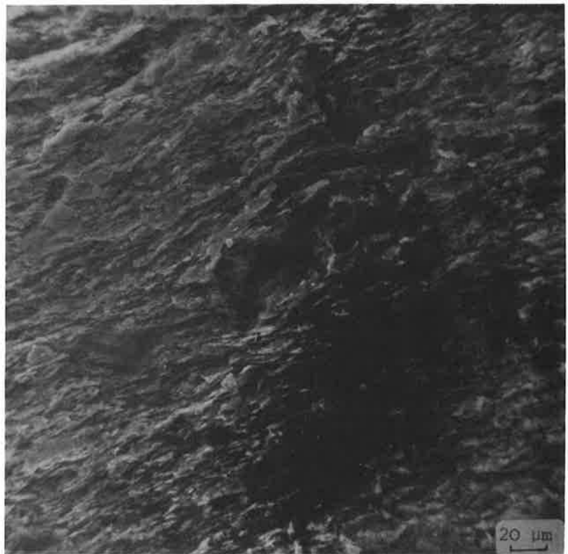
FIGURE 8 - Observation au M.E.B. de BN comprimé à chaud.
