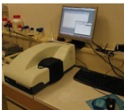
**Figure 2.8.** Zetasizer NanoZS de Malvern<sup>®</sup> (IC2MP<sup>1</sup>, Université de Poitiers).
