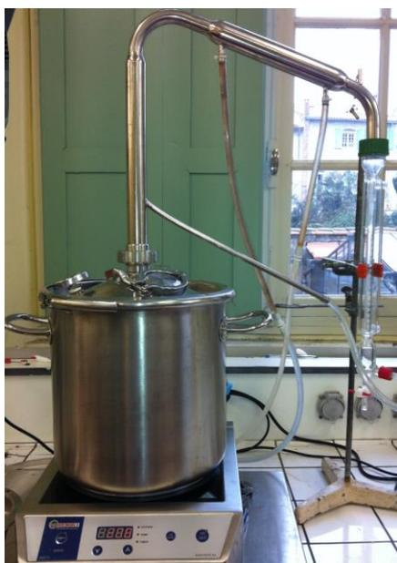
Figure II.12. Photographie du montage d'hydrodistillation.
