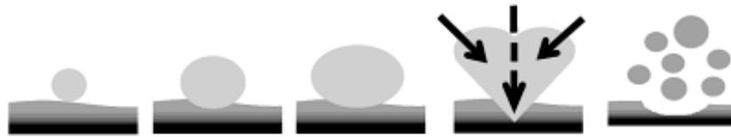
Figure V.6. Destruction de l'interface solide-liquide par cavitation ultrasonore. [14]
