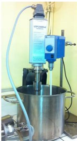
Figure II.15. Photographie du montage de prétraitement par ultrasons.
