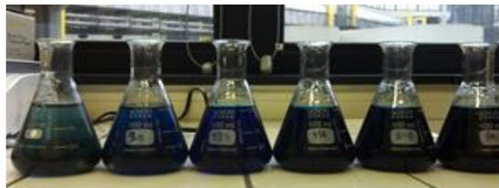
Figure IV.4. Photographie du charbon actif dilué dans les solutions aqueuses de bleu de méthylène ; C [30-200 mg/ml], de gauche à droite.
