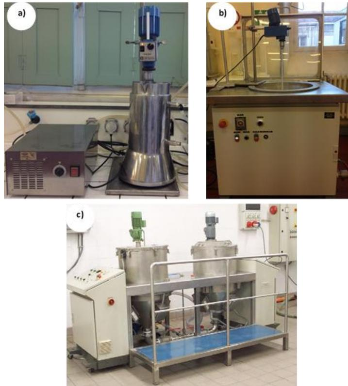
Figure V.8. Réacteurs à ultrasons de la société REUS ; (a) équipement de laboratoire de 3 L ; (b) réacteur pilote de 30 L ; (c) réacteur industriel de 500 L.
