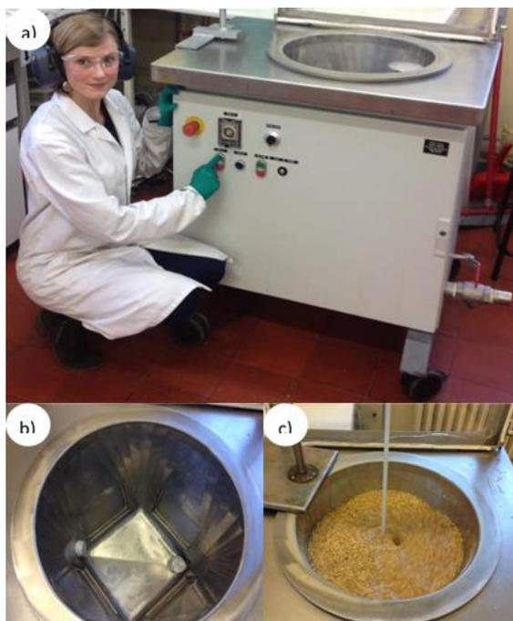
Figure V.20. *Appareil à ultrasons à l'échelle pilote (a) ; (b) vue intérieure du réacteur pilote; (c) UAE des sciures de pin maritime.*
