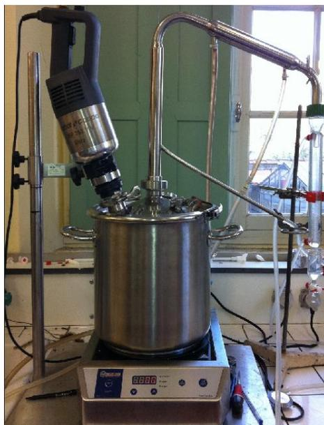
Figure II.13. Photographie du montage de turbohydrodistillation.
