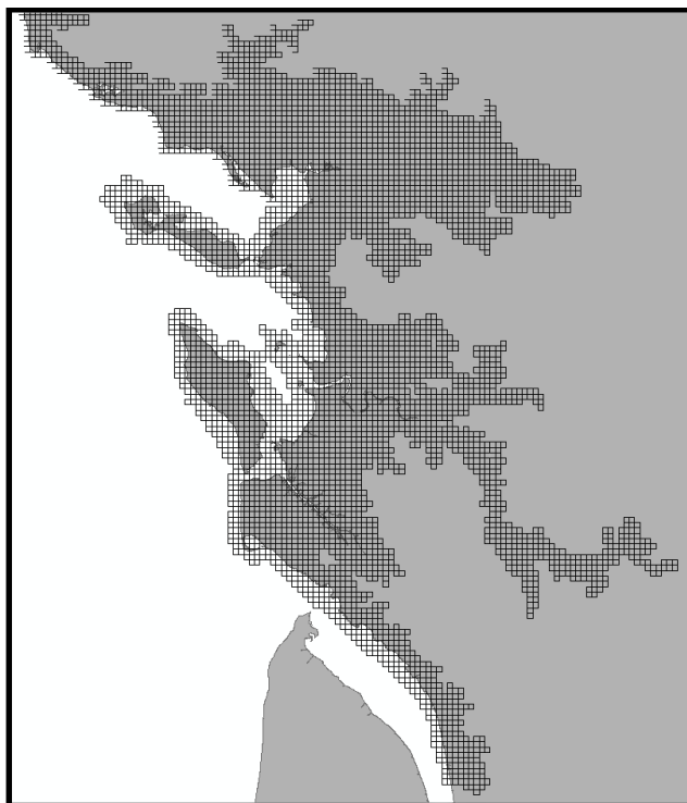
Figure 2.7: Représentation de la couverture des 5000 dalles LiDAR fournies par l'IGN pour la zone Sud-Vendée et Charente-Maritime.
