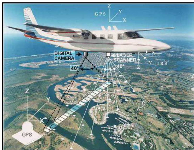
Figure 2.6: Représentation schématique du dispositif d'acquisition LiDAR. Source : Terra Imaging.
