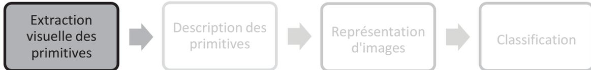
FIGURE 1.2.1 – Architecture d'un système de reconnaissance d'objets
