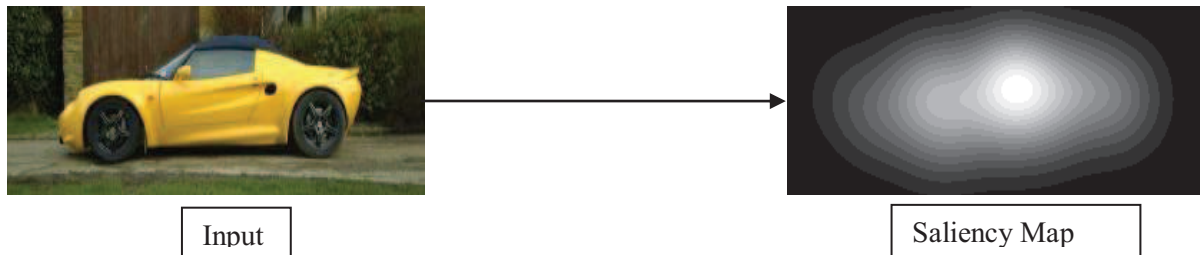
FIGURE 2.3.3 – carte de saillance S(I, t) calculée par le système de Perreira da silva
