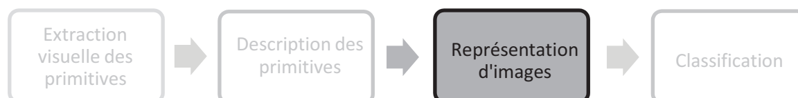
FIGURE 1.4.1 – Architecture simple d'un système de reconnaissance d'objets
