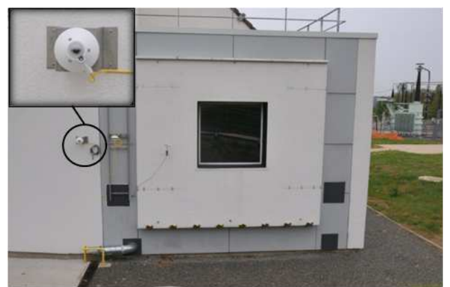
b) Localisation du pyranomètre placé sur la paroi Ouest de la cellule étudiée
