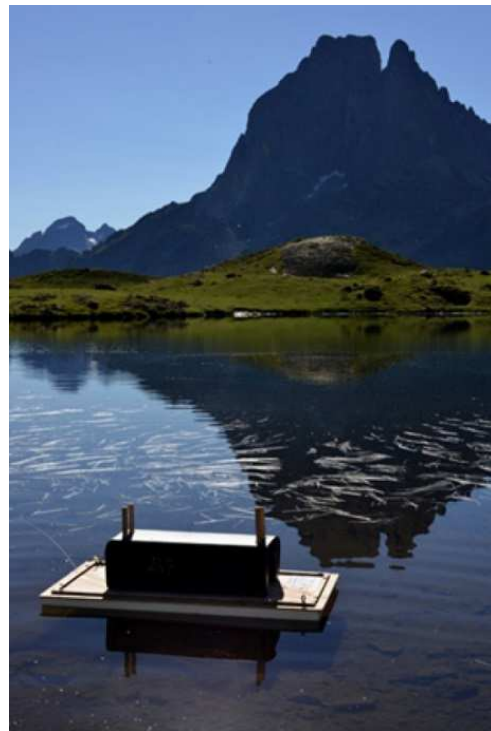
Figure 25. Radeau à empreintes flottant installé sur un des lacs d'Ayous dans le cadre d'un projet LIFE+ (© F. Blanc).
