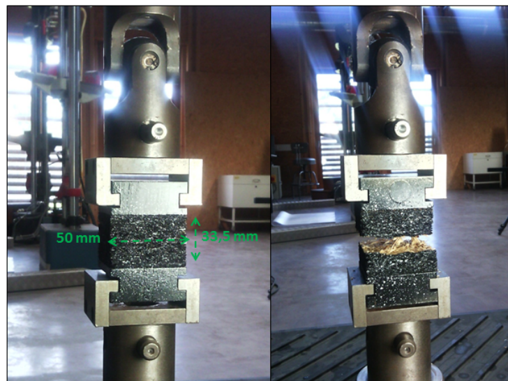
Figure 2.38 – Éprouvette de traction et essai de traction hors plan avant et après rupture.
