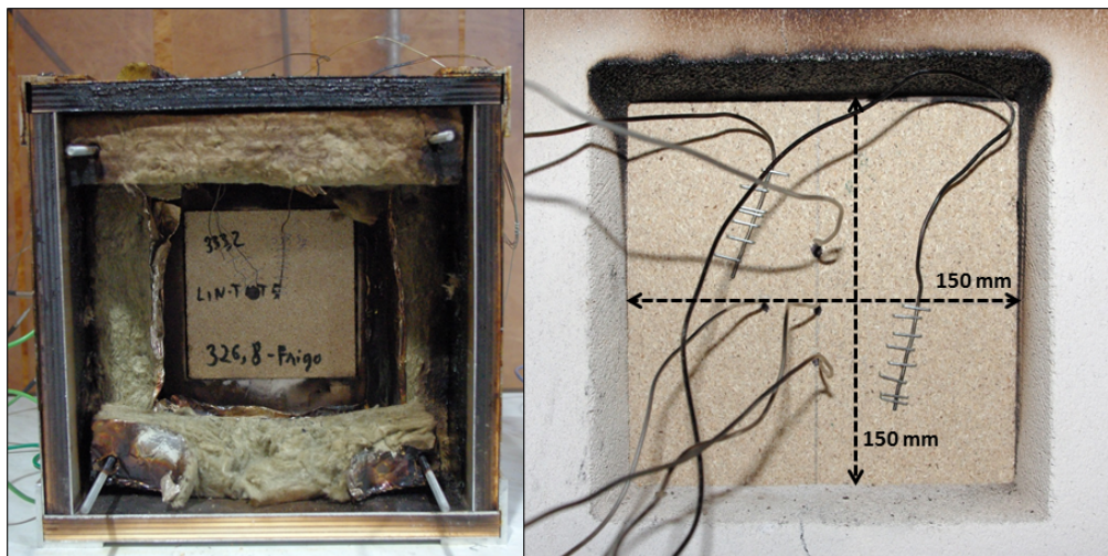
Figure 2.20 – Vue de l'intérieur du four d'essai (à gauche) et vue de la face non-exposée (à droite) d'un échantillon d'aggloméré de lin lors d'un essai de transfert thermique.
