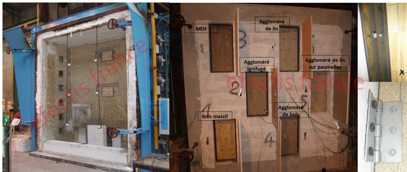
Figure 2.46 – À gauche, vue de la chambre du four d'essai ; au centre, vue de la face non-exposée des échantillons testés lors de l'essai à grande échelle (dimensions : 3 x 3 m 2 ) ; en haut à droite, zoom sur une fixation par cornière ; en bas à droite, zoom sur une paumelle.
