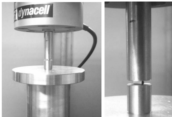
Figure 2.5 : Dispositif de test à l'écrasement d'un support cylindrique.
