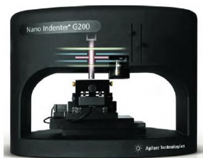
Figure 2.21 : Nanoindenteur G200 d'Agilent Technologies utilisé pour les mesures d'indentation sphérique.
