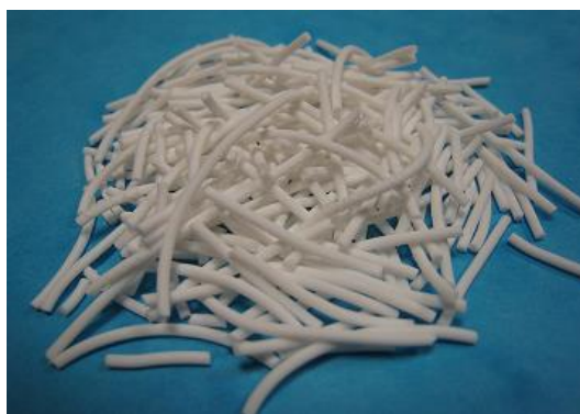
Figure 2.1 : Lot d'extrudés cylindriques obtenus après mise en forme par extrusion à IFPEN.
