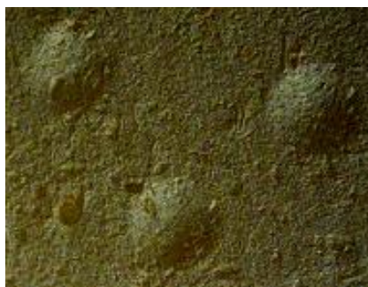
Figure 5.6 : Empreintes résiduelles obtenues après les essais d'indentation réalisés à différentes vitesses de chargement avec la pointe D600 sur un échantillon monomodal. Le rayon mesure ~72 μm pour toutes les empreintes.
