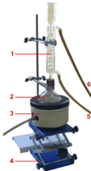
Figure 2.11 Montage expérimental pour la réalisation des NPs de 3C-SiC par attaque chimique
