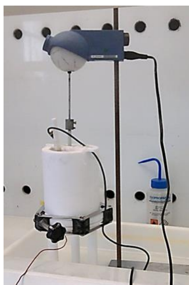
Figure 2.1 Montage d'une réaction d'anodisation électrochimique de Silicium.
