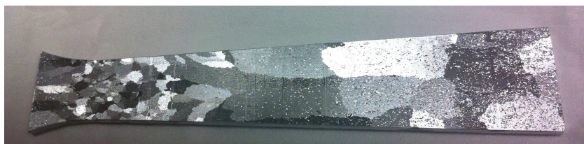
(b) Pré-érouissage d’environ 4% au milieu de l’éprouvette Trap 4
