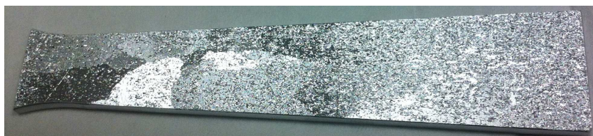
(a) Pré-érouissage d’environ 2% au milieu de l’éprouvette Trap 2
