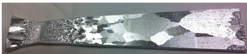
(c) Pré-érouissage d’environ 6% au milieu de l’éprouvette Trap 6
