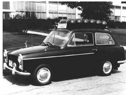
(d) Austin hybride de Karl Kordesch - pile à combustible alcaline et batteries au plomb (1970)
