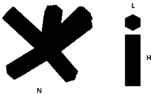
Figure IV 12 : Schémas indiquant les paramètres L et H utilisés pour simuler les cristaux de type Rosettes. Et N est le nombre de Bullet qui forment le cristal.
