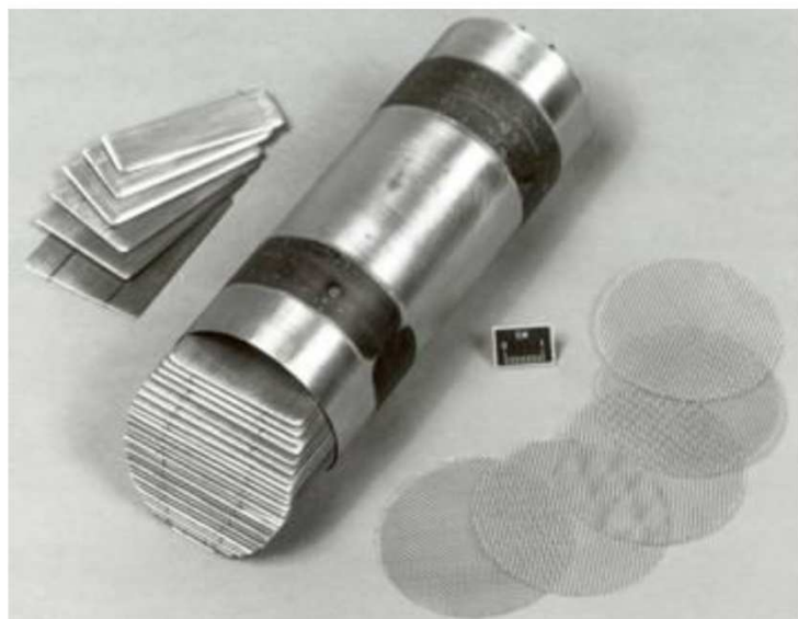
Figure 1.14 : Réfrigérateur magnétique fonctionnant à température ambiante conçu en 1976 [25]
