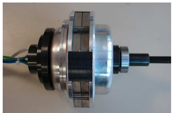
Figure 3.24 : Stator inséré au centre du rotor
