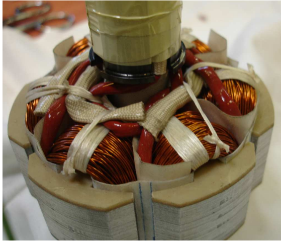
Figure 3.20 : Vue de détail des têtes de bobines du stator
