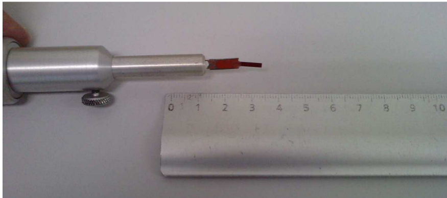
Figure 3.30 : Sonde à effet Hall du gaussmètre utilisée pour les mesures d'induction effectuées dans l'entrefer du prototype
