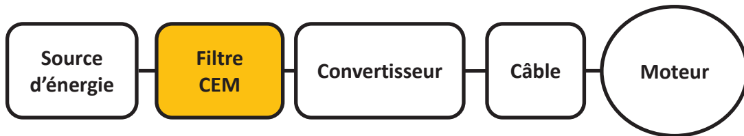
Figure I-5 Exemple d'une chaîne de conversion
