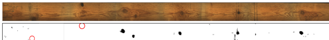
FIGURE 2.13: Problèmes identifiés dans le seuillage automatique
