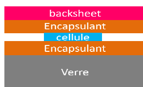
Figure Annexe 11 : Encapsulation d'une cellule par deux membranes entre une lame de verre et une face arrière Tedlar®-PET-Tedlar®.
