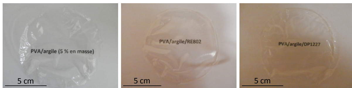
Figure V.12 : Photographies des membranes PA, PAR et PAD27 réalisées dans des boîtes de pétri en verre de 9,8 cm de diamètre.
