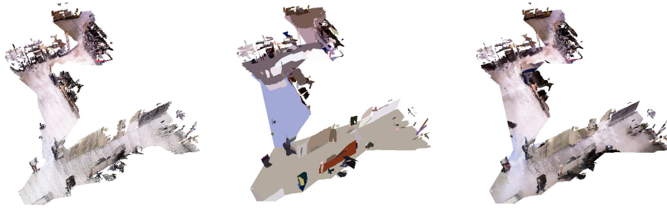
FIGURE 1.2 – De gauche à droite : représentation de l’environnement sous forme de nuage de points, de plans puis de plans texturés. Sur la carte du milieu composée de plans non texturés, le problème de la dérive de l’odométrie dans les cartes métriques est bien visible : le sol est matérialisé par 3 plans distincts au lieu d’un seul du fait des erreurs de reconstruction de la carte.
