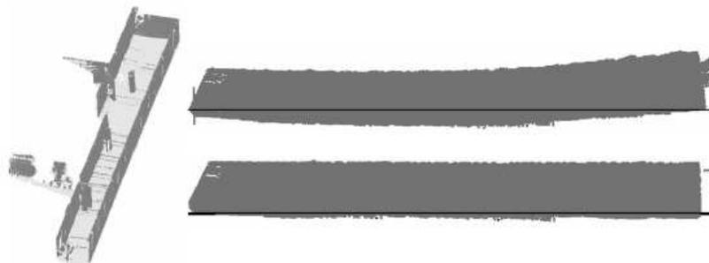
**FIGURE 2.2** – Exemple d'utilisation de l'information sémantique pour contraindre la construction 3D ([Nuchter et Hertzerg 2008]). Comprendre la planéité du sol et des murs permet de corriger la dérive de l'odométrie.
