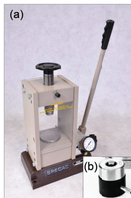
Figure III.36 : (a) presse et (b) moule utilisés pour le calandrage
