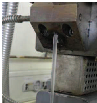
Figure III.14 : extrudât obtenu à partir du mélange PVDF/carbonate de propylène à 120°C
