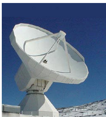
FIGURE 4.2 – Radiotélescope à antenne unique de 30 mètres de diamètre de l'IRAM (Pico Veleta, Espagne).
