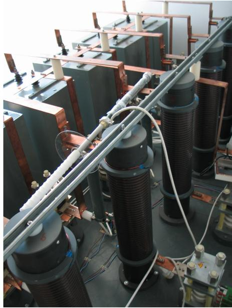
FIGURE 2.28 – Photographie de l'un des générateurs pulsés utilisés pour produire le champ magnétique transverse de l'expérience BMV. On peut y voir les condensateurs (parallélépipèdes) placés derrière les bobines de protection (cylindres), et enfin les thyristors au premier plan.
