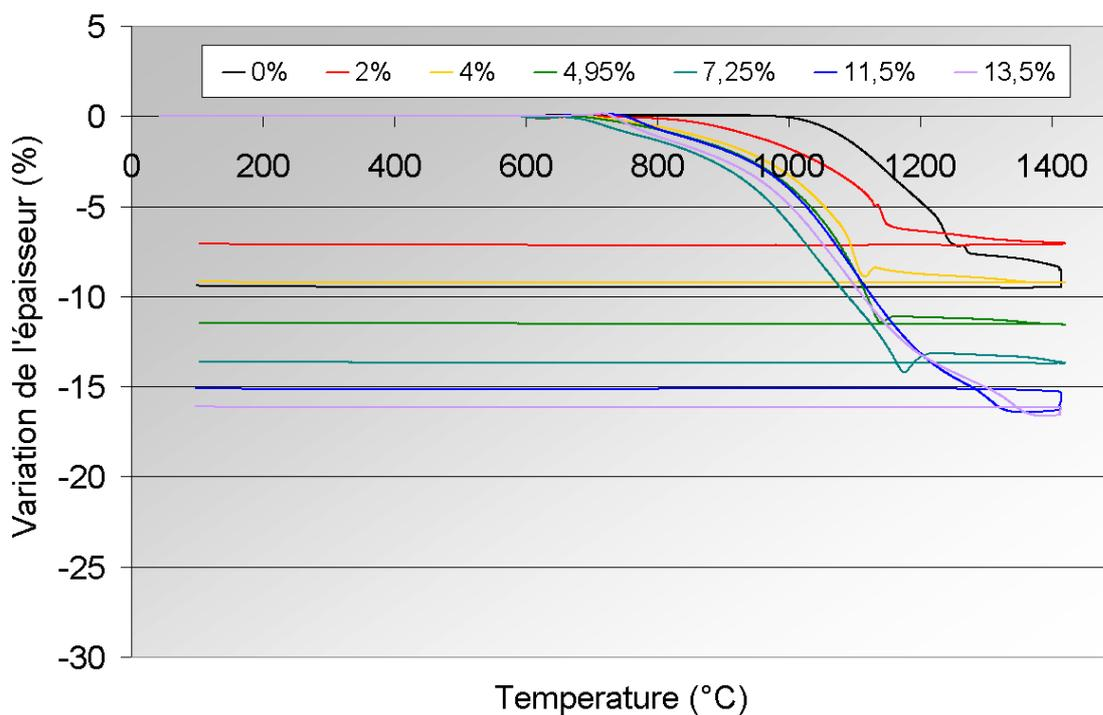
Fig. A11. Evolution des courbes dilatométrique du BAM précalciné à 900°C en fonction de la quantité de LiF ajouté
