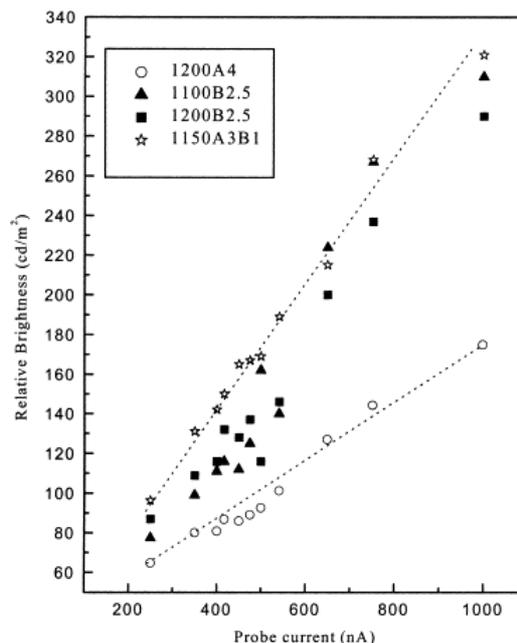
Fig. I.36. Brillance de poudre d' $Y_2O_2S : Eu$  selon le fondant et la température de calcination, en fonction du courant appliqué
