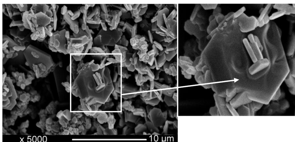
Fig. IV.10. Micrographie de BAM prétraité à  $900^\circ C$  sous air, puis calciné à  $1400^\circ C$  sous argon pendant 1 h en présence de 9,2% volumique de  $MgF_2$
