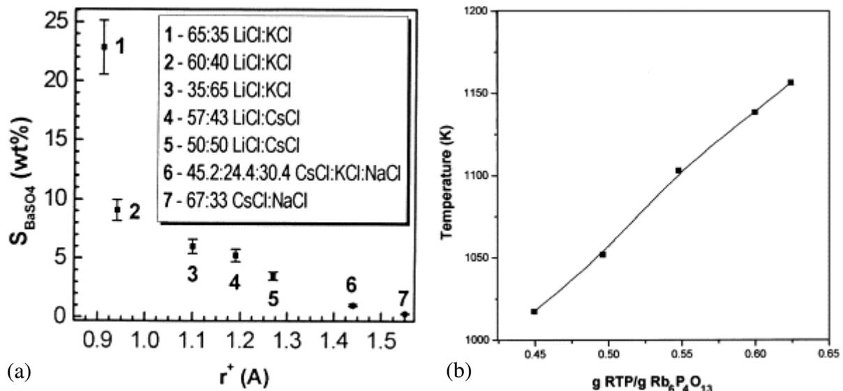
Fig. I.27. (a), Solubilité de  $\text{BaSO}_4$  en fonction du rayon moyen du cation utilisé dans le solvant et (b), diagramme de solubilité de  $\text{RbTiOPO}_4$  (RTP) dans le fondant  $\text{Rb}_6\text{P}_4\text{O}_{13}$ .
