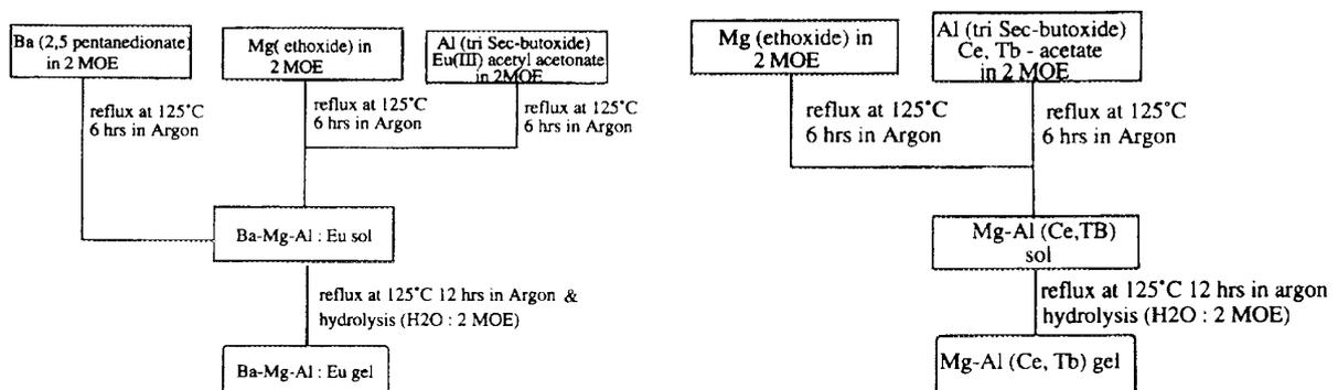
Fig. I.16. a) Séquence de réactions utilisée pour la formation de  $BaMgAl_{16}O_{27} :Eu$  et b), séquence de réactions utilisée pour la formation de  $MgAl_{11}O_{17,5} :Ce$  [I29]
