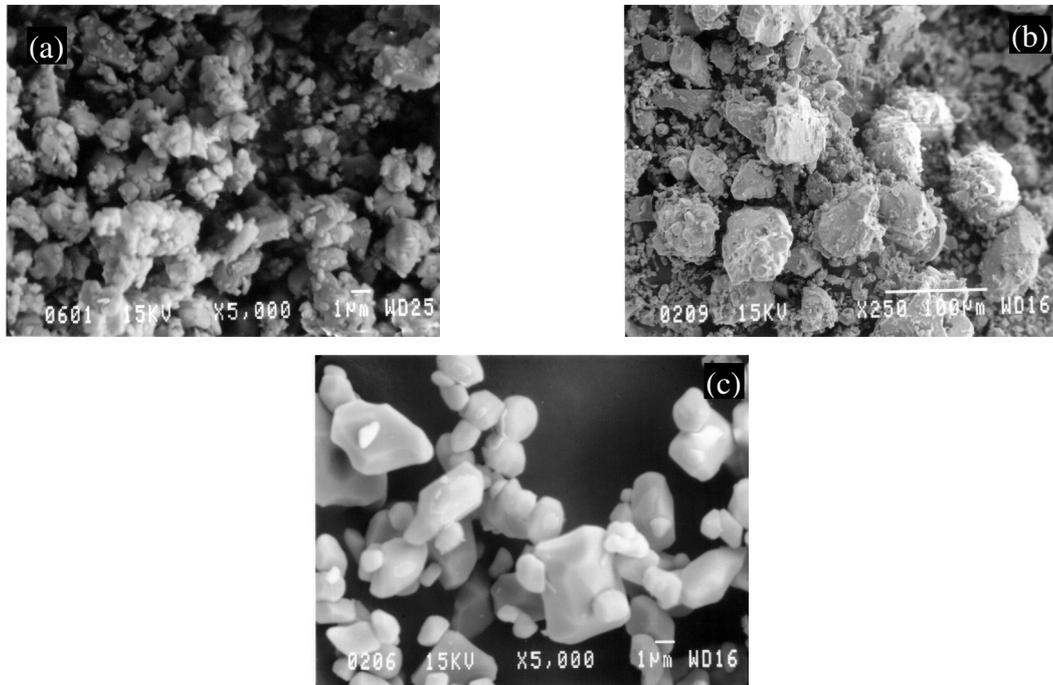
Fig. I.25.  $\text{LaPO}_4, x\text{H}_2\text{O} / \text{Li}_2\text{CO}_3$  1% calciné à 800°C (a), 1200°C (b) et à 1000°C (c) à 5°C.min<sup>-1</sup>
