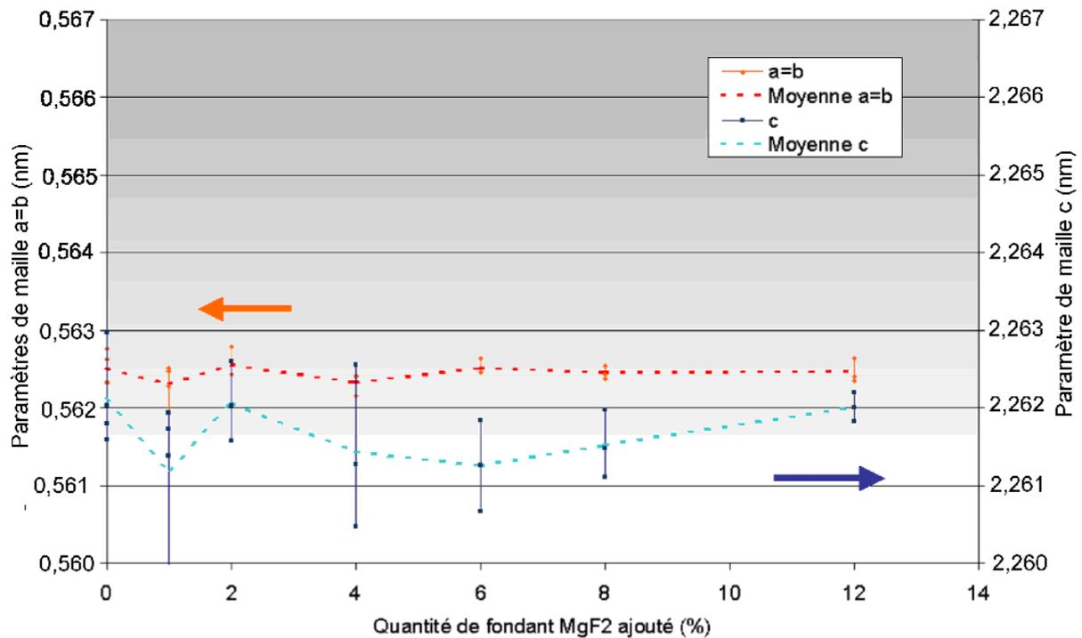
Fig. III.9. Evolution des paramètres de maille du BAM calciné à 1600°C en fonction de la quantité de  $MgF_2$  ajouté
