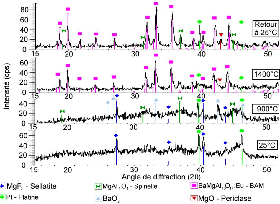
Fig. A6. Composition de la poudre de précurseur précalcinée à 900°C + 4,6% volumique de MgF<sub>2</sub>, à différentes températures pendant le traitement thermique
