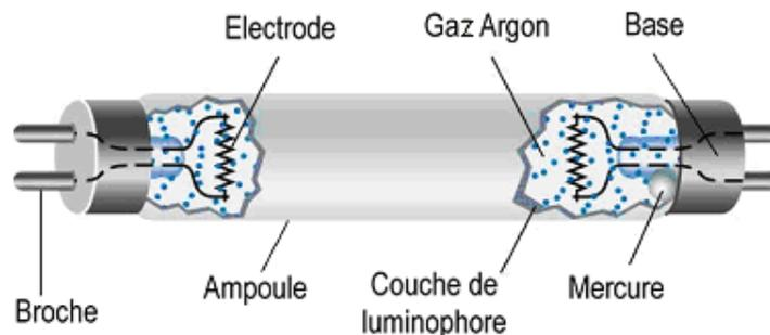
Fig. I.10. Schéma de principe d'une lampe fluorescente
