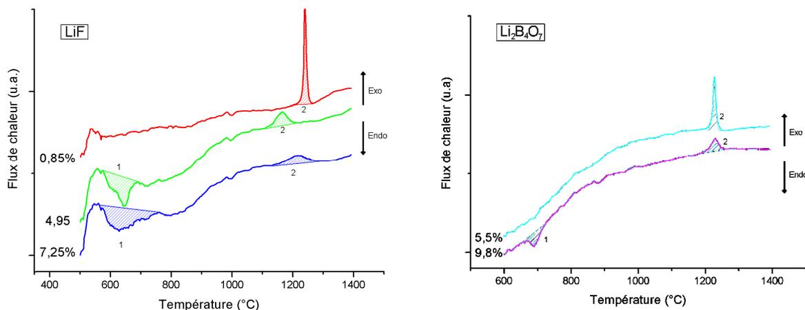
Fig. IV.31. ATD du BAM avec divers ajouts de LiF et Li<sub>2</sub>B<sub>4</sub>O<sub>7</sub>. 1 : Pic endothermique correspondant à une fusion et 2 : pic exothermique correspondant à la cristallisation du BAM
