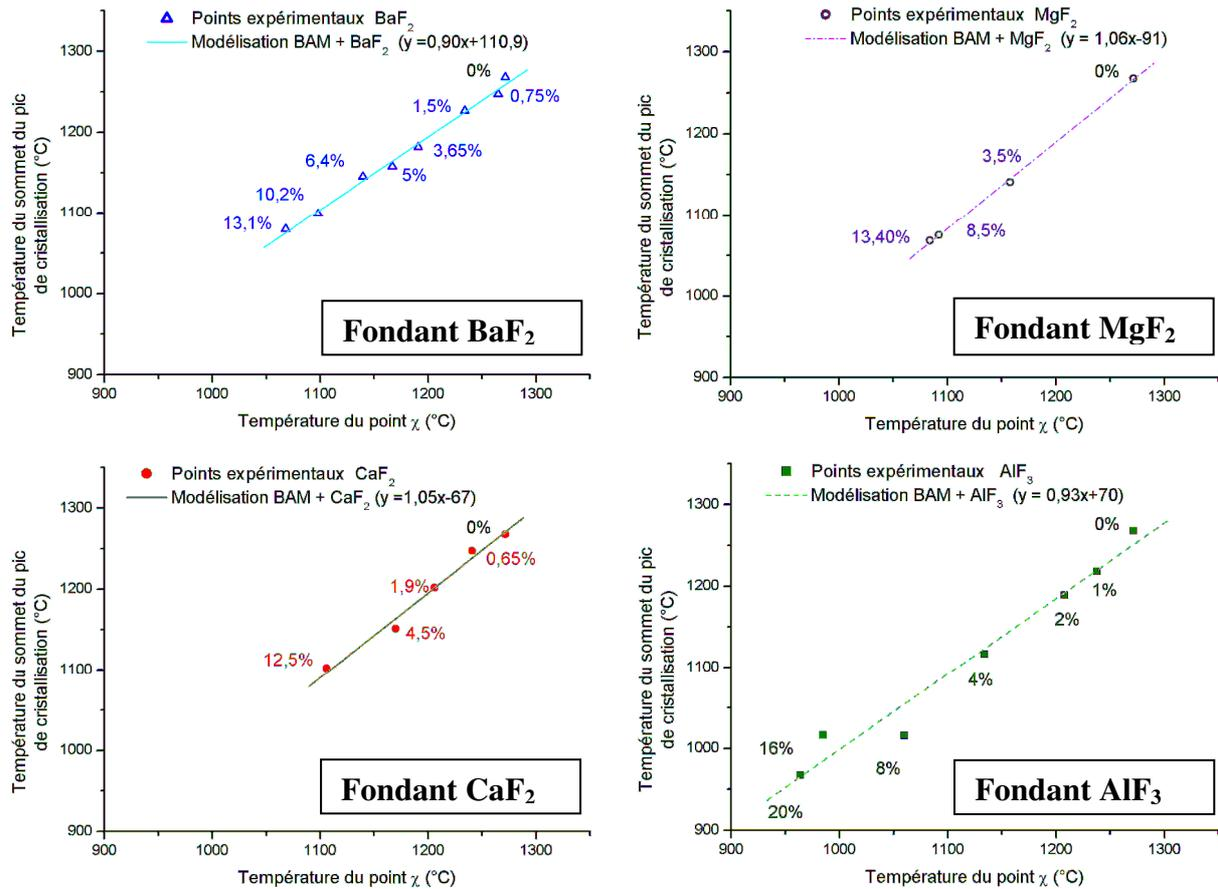
Fig. IV.26. Corrélation entre la température du point  $\chi$  et la température de fin de cristallisation pour les fondants BaF<sub>2</sub>, MgF<sub>2</sub>, AlF<sub>3</sub> et CaF<sub>2</sub>
