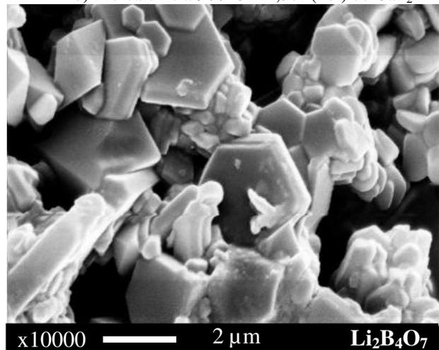
d) Pré-calciné à 900°C + 2,9% (vol) de Li<sub>2</sub>B<sub>4</sub>O<sub>7</sub>
