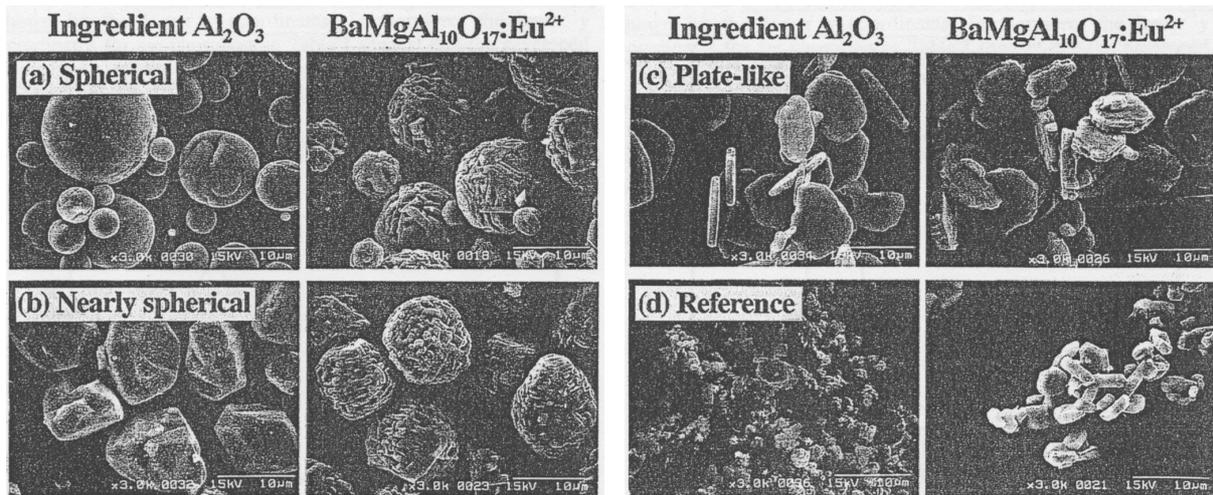
Fig. I.21. Micrographies MEB d'Al<sub>2</sub>O<sub>3</sub> et de BaMgAl<sub>10</sub>O<sub>17</sub>:Eu obtenu sans fondant à une température de calcination supérieure à 1700°C (a-c) et de la référence de BaMgAl<sub>10</sub>O<sub>17</sub>:Eu préparé avec AlF<sub>3</sub> comme fondant d'après Oshio et al..
