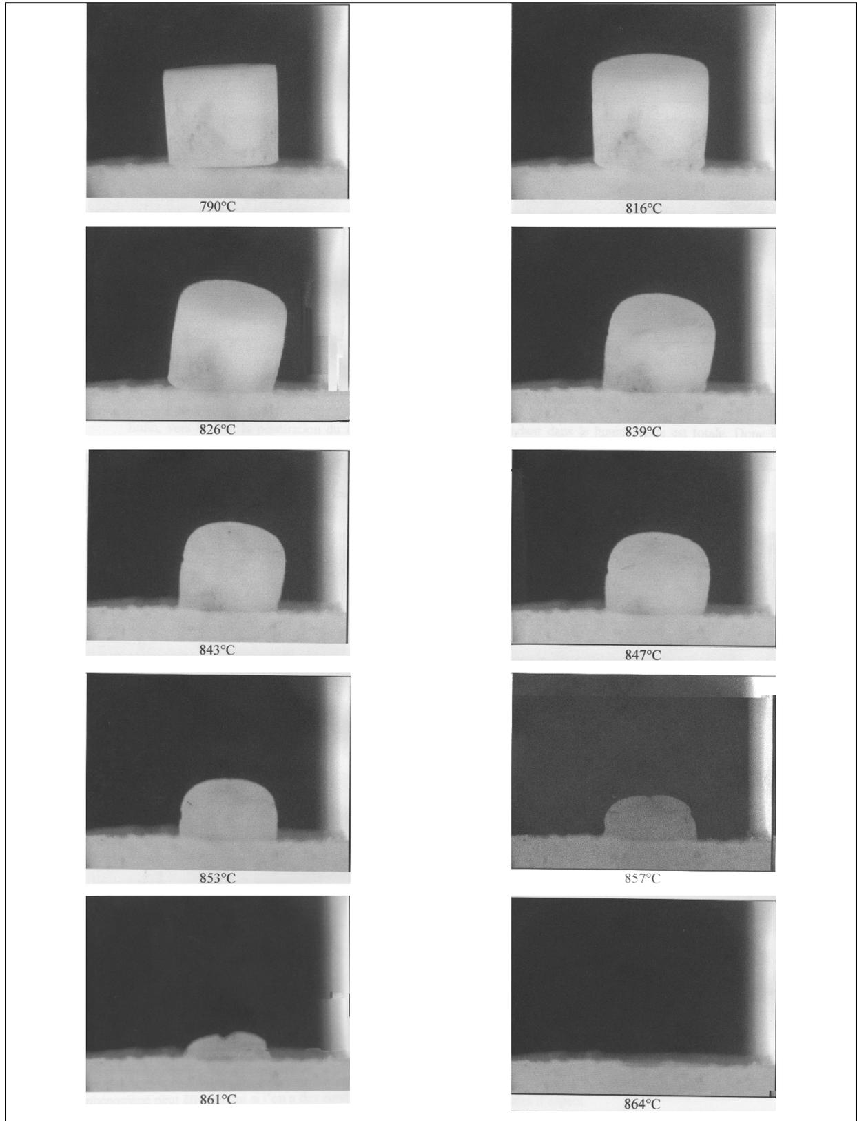
Fig. V.5. Evolution du comprimé de LiF sur un substrat de précurseur, précalciné à 900°C, en fonction de la température
