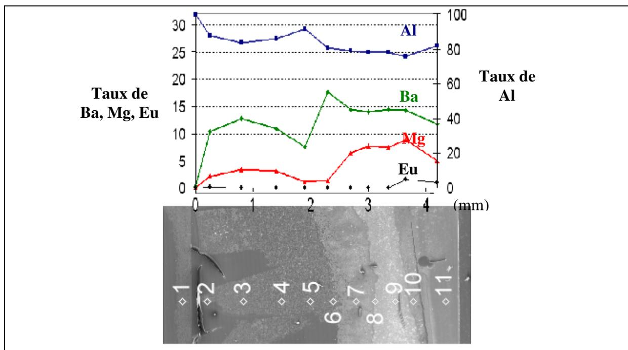
Fig. V.19. Evolution du taux des éléments Al, Ba, Mg et Eu, en fonction de la profondeur, réalisé grâce à une sonde EDS
