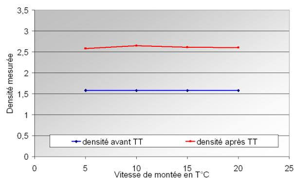
Fig. IV.21. Evolution de la densité des pastilles de BAM pré-calciné à 900°C, plus 16% atomique de  $\text{Li}_2\text{B}_4\text{O}_7$ , avant et après les expériences de dilatométrie, en fonction de la vitesse de calcination
