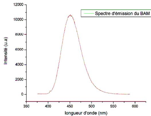
Fig. I.3. Spectre d'émission du BAM (température ambiante)
