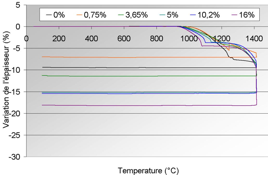
Fig. A12. Evolution des courbes dilatométrique du BAM précalciné à 900°C en fonction de la quantité de BaF<sub>2</sub> ajouté
