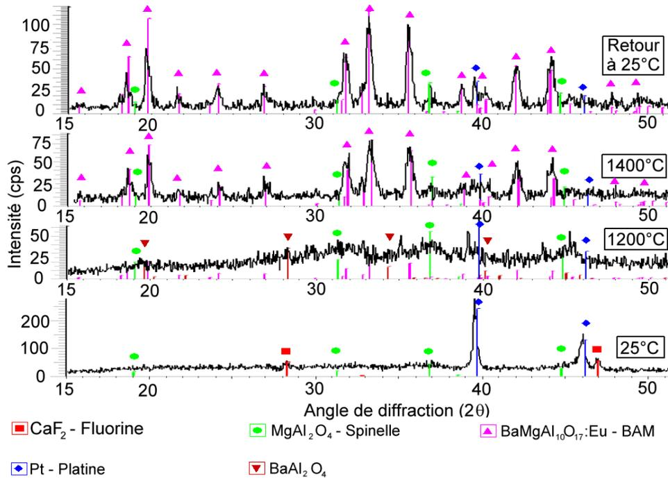
Fig. A4. Composition de la poudre de précurseur précalcinée à  $900^\circ\text{C}$  + 4,5% volumique de  $\text{CaF}_2$ , à différentes températures pendant le traitement thermique
