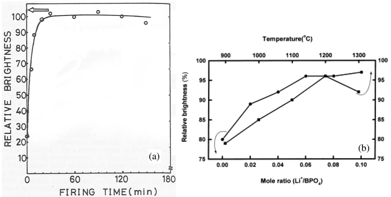
Fig. I.22. (a) Brillance relative d' $\text{Y}_2\text{O}_2\text{S} : \text{Eu}$  calciné à  $1180^\circ\text{C}$  en fonction de la durée de palier [I39] et (b) brillance relative de  $\text{La}(\text{BO}_3, \text{PO}_4) : \text{Ce}, \text{Tb}, \text{Gd}$  en fonction de la température de calcination et de la quantité de fondant ajouté [I40].
