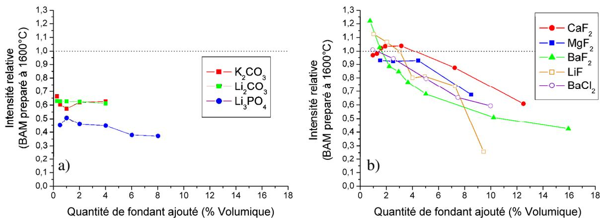
Fig. III.18. Evolution de la fluorescence sous UV 254 nm du BAM calciné à 1400°C sous Ar/H<sub>2</sub> pendant 2 h en fonction du pourcentage volumique de fondant introduit
