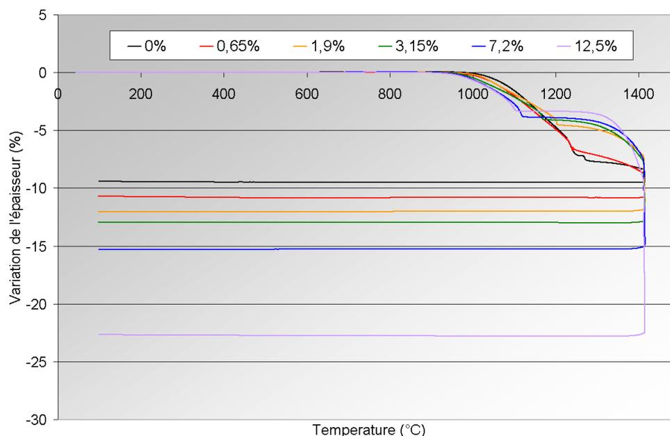
Fig. IV.22. Evolution des courbes dilatométrique du BAM précalciné à 900°C en fonction de la quantité de CaF<sub>2</sub> ajouté
