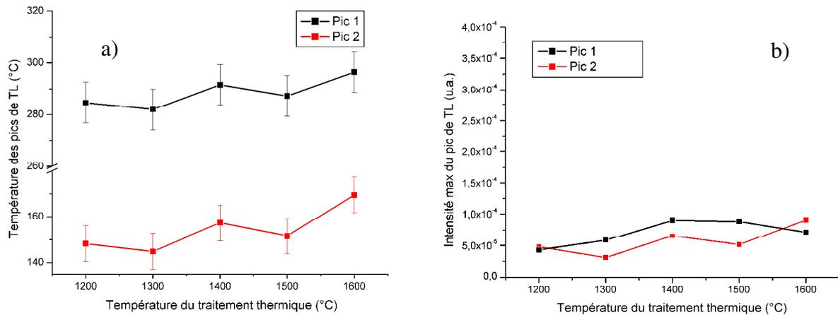
Fig. III.15. Evolution de la température (a) et de l'intensité (b), des pics de TLN, entre 50°C et 500°C, en fonction de la température maximale du traitement thermique de 1200°C à 1600°C
