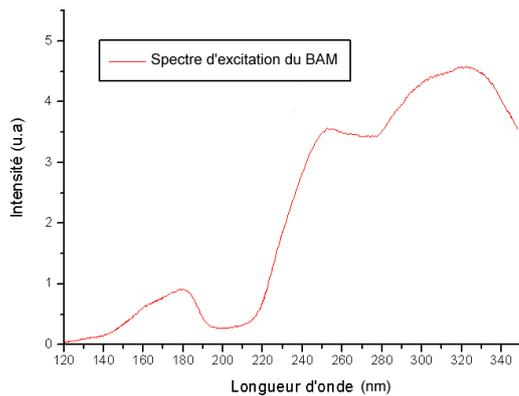
Fig. I.2. Spectre d'excitation du BAM (température ambiante)
