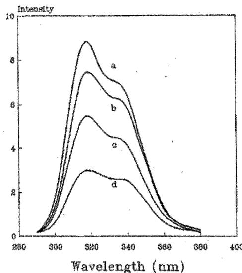
Fig. I.28. Spectres d'émission de  $LaPO_4:Ce$  [I53] sous atmosphère réductrice (CO) ou oxydante (air), (a) dopé au lithium (CO), (b) non-dopé (CO), (c) dopé au lithium (air) et (d) non dopé (air)
