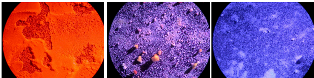
(a) Précurseur de BAM calciné à 900°C sous Air (b) BAM calciné à 1600°C sous O 2 (c) BAM calciné à 1600°C sous Ar/H 2
