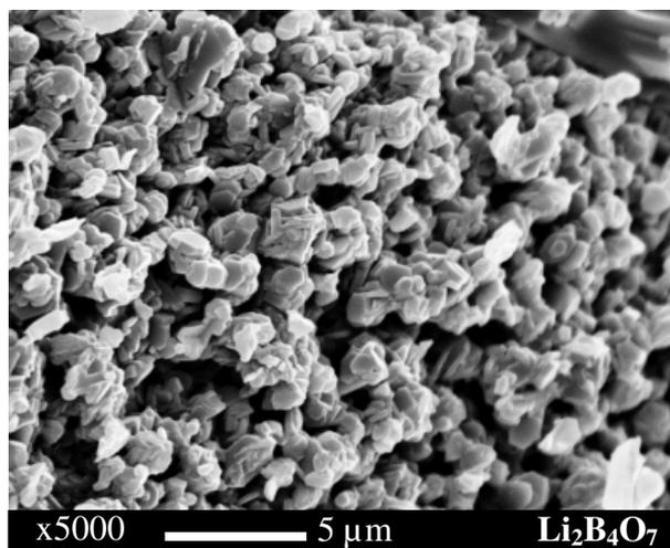
d) Pré-calciné à 1200°C + 2,9% (vol) de  $\text{Li}_2\text{B}_4\text{O}_7$
