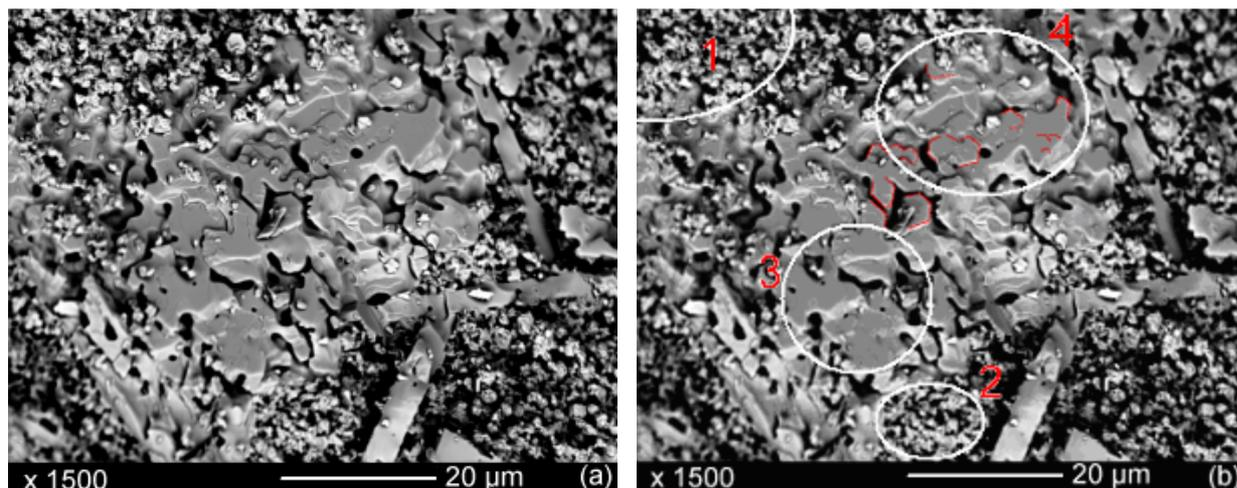
Fig. IV.11. Micrographies en électrons rétrodiffusés de BAM prétraité à 1200°C sous air, puis calciné à 1400°C sous argon pendant 1 h en présence de 2,9% volumique de  $\text{Li}_2\text{B}_4\text{O}_7$ . (a) micrographie brute et (b) micrographie annotée
