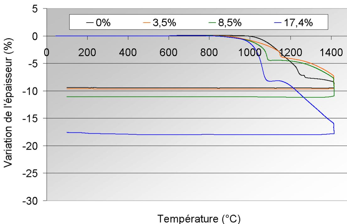
Fig. A13. Evolution des courbes dilatométriques du BAM précalciné à 900°C en fonction de la quantité de MgF<sub>2</sub> ajouté
