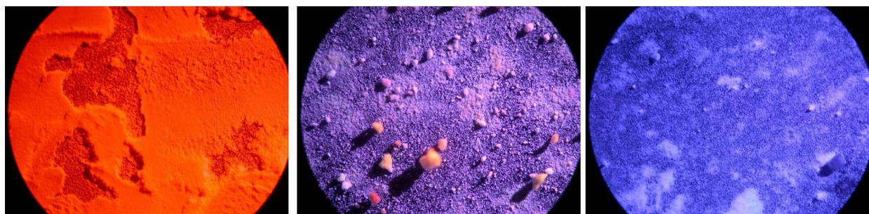
(a) Précurseur de BAM calciné à 900°C sous Air (b) BAM calciné à 1600°C sous O<sub>2</sub> (c) BAM calciné à 1600°C sous Ar/H<sub>2</sub>
