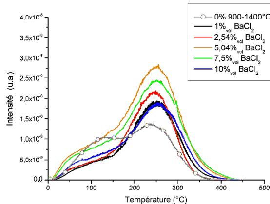
Fig. III.25. Evolution de la thermoluminescence du BAM prétraité à 900°C sous air puis calciné à 1400°C sous atmosphère réductrice pendant 2 h avec l'ajout de  $BaCl_2$ , irradié sous UV 254 nm.
