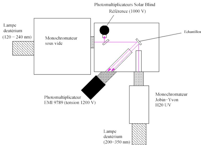
Fig. II.9. Schéma de l'enceinte expérimentale : spectrométrie d'excitation
