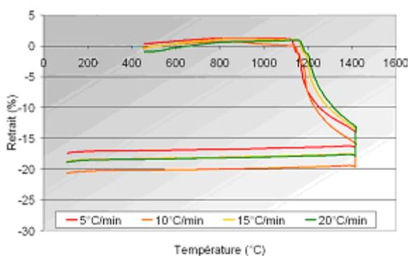
Fig. IV.20. Evolution de l'épaisseur de comprimés de poudre de BAM pré-calciné à 900°C, avec ajout de 16% atomique de  $\text{Li}_2\text{B}_4\text{O}_7$ , en fonction de la vitesse de calcination lors de l'analyse par dilatométrie
