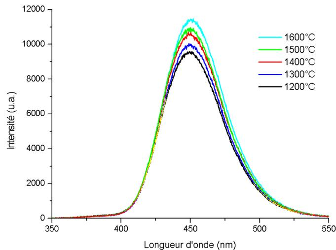
Fig. II.11. Spectre de fluorescence du BAM calciné pendant 2h sous Ar/H<sub>2</sub> 5% à différentes températures
