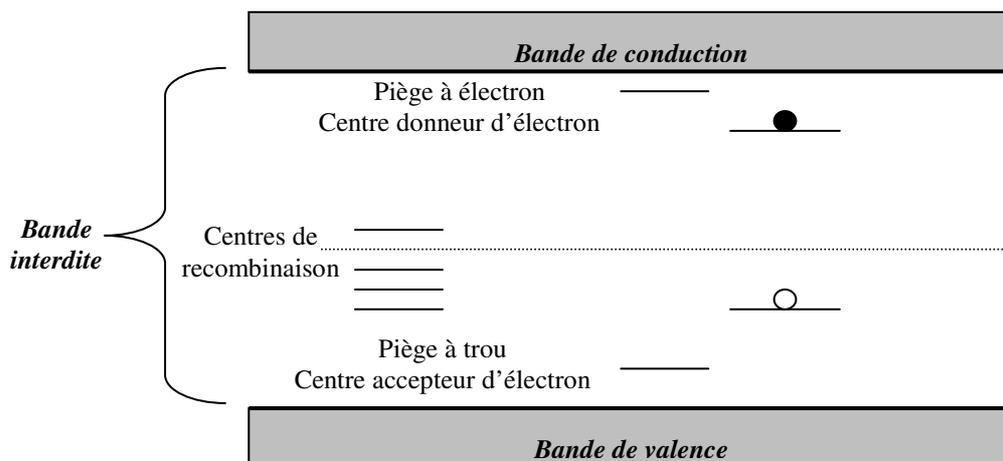
Fig. A2. Niveaux d'énergie impliqués dans les mécanismes de TL
