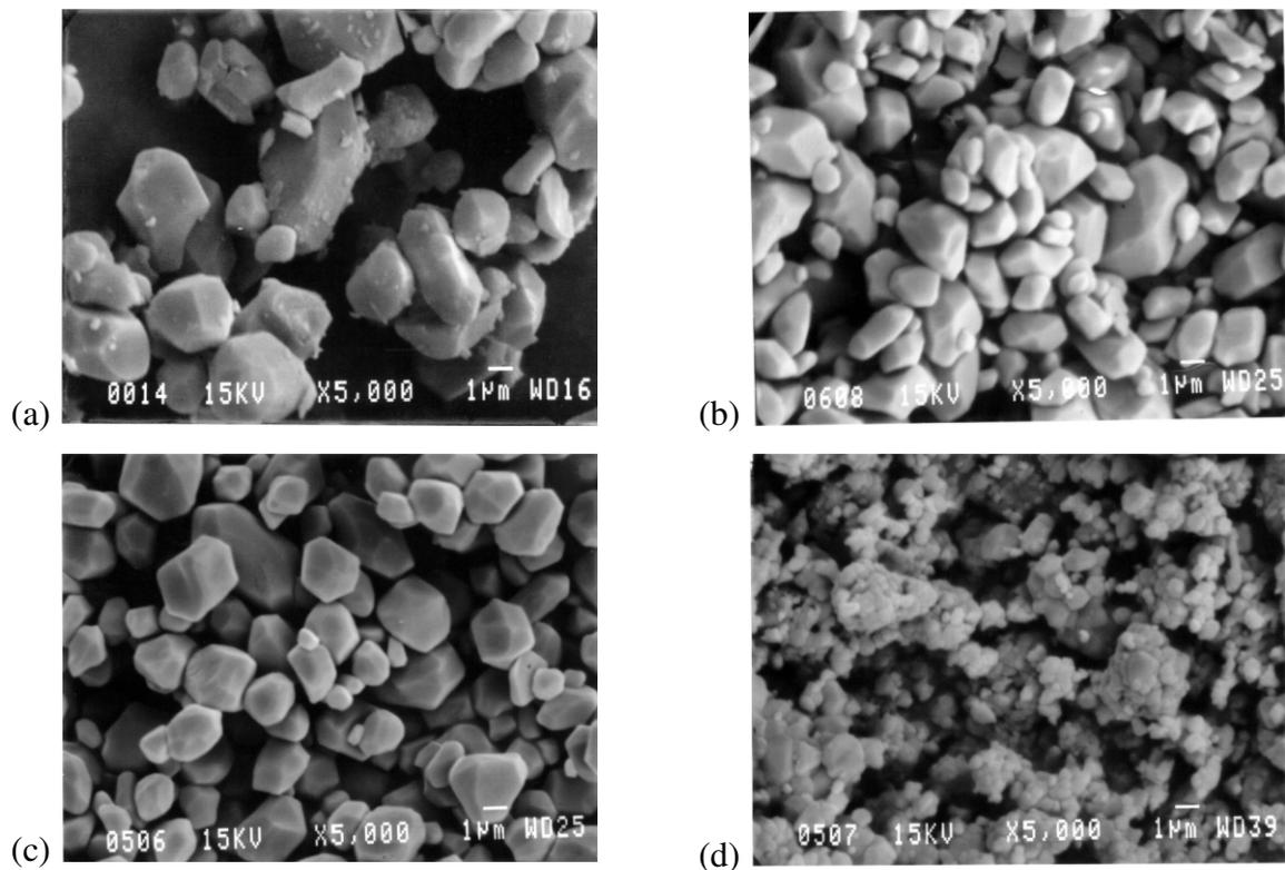
Fig. I.31. Micrographies MEB représentant l'évolution de la morphologie du phosphate de lanthane calciné à 1000°C selon le fondant utilisé : (a) 1%  $\text{Li}_2\text{CO}_3$ , (b) 1%  $\text{Li}_3\text{PO}_4$ , (c) 1,4%  $\text{Na}_2\text{CO}_3$  et (d) 1,9%  $\text{K}_2\text{CO}_3$
