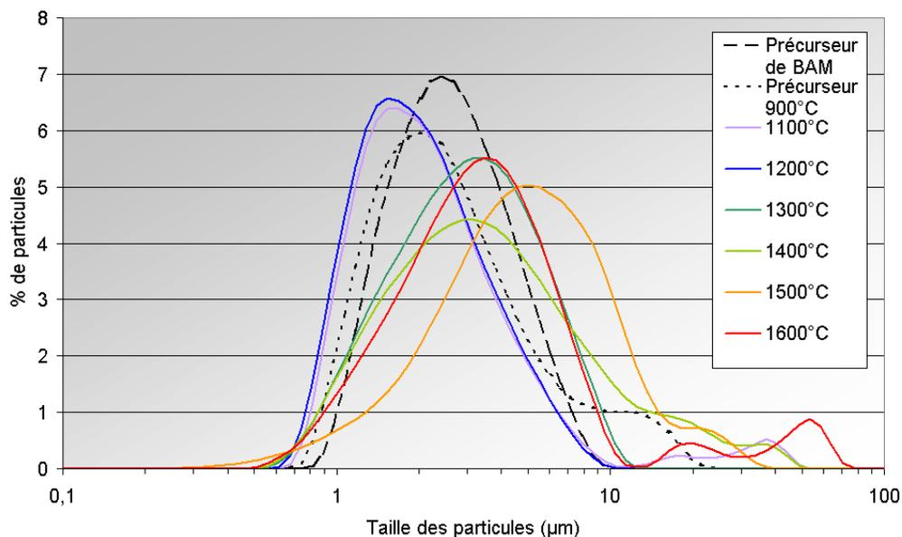
Fig. II.5. Répartition granulométrique du BAM fourni par Rhodia en fonction du traitement thermique subi : Précurseur sans traitement thermique, Précurseur après 2h à  $900^\circ\text{C}$  sous air et  $1200^\circ\text{C}$  à  $1600^\circ\text{C}$  après 2h à la température indiquée sous argon hydrogéné à 2%.
