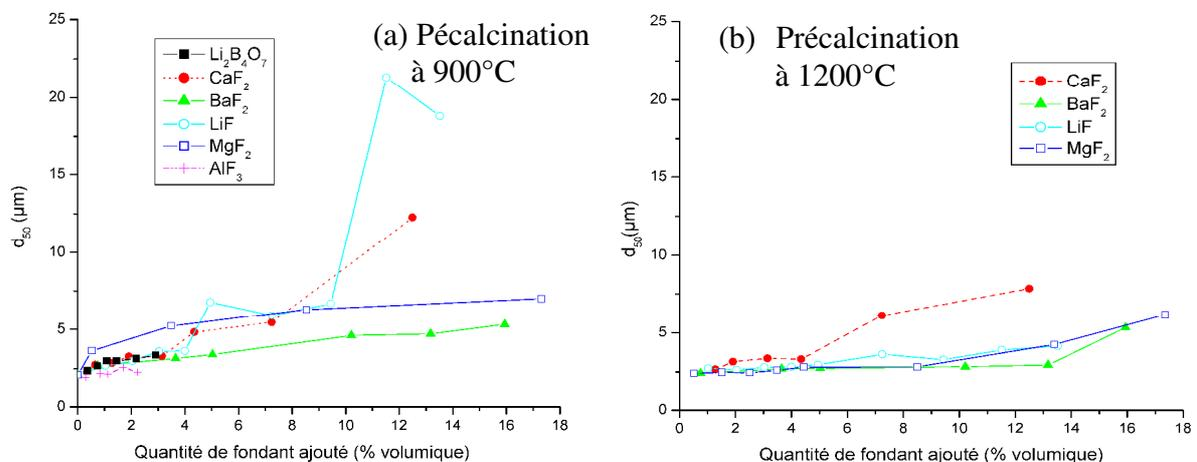
Fig. IV.2. Evolution du diamètre médian  $d_{50}$  (a) du BAM précalciné à  $900^\circ\text{C}$  puis calciné à  $1400^\circ\text{C}$  sous  $\text{Ar}/\text{H}_2$  et (b) du BAM précalciné à  $1200^\circ\text{C}$  puis calciné à  $1400^\circ\text{C}$  sous  $\text{Ar}/\text{H}_2$ , en fonction de la quantité de fondant ajouté
