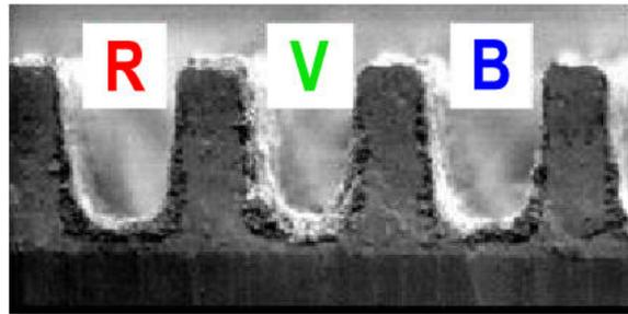
Fig. I.9. Couches de luminophores déposées par sérigraphie
