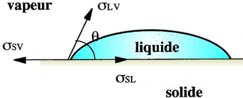
Fig. A18. Schématisation d'une interface solide-liquide
