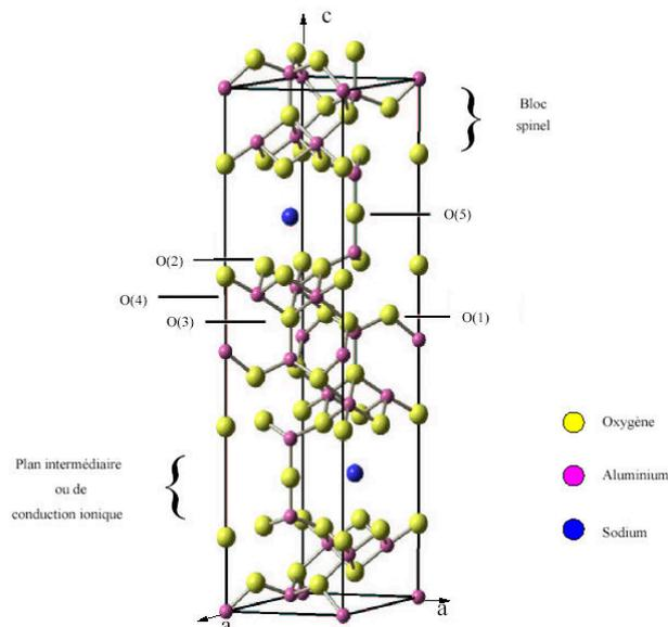
Fig. III.11. Structure cristalline de la  $\beta$ -alumine :  $NaAl_{11}O_{17}$
