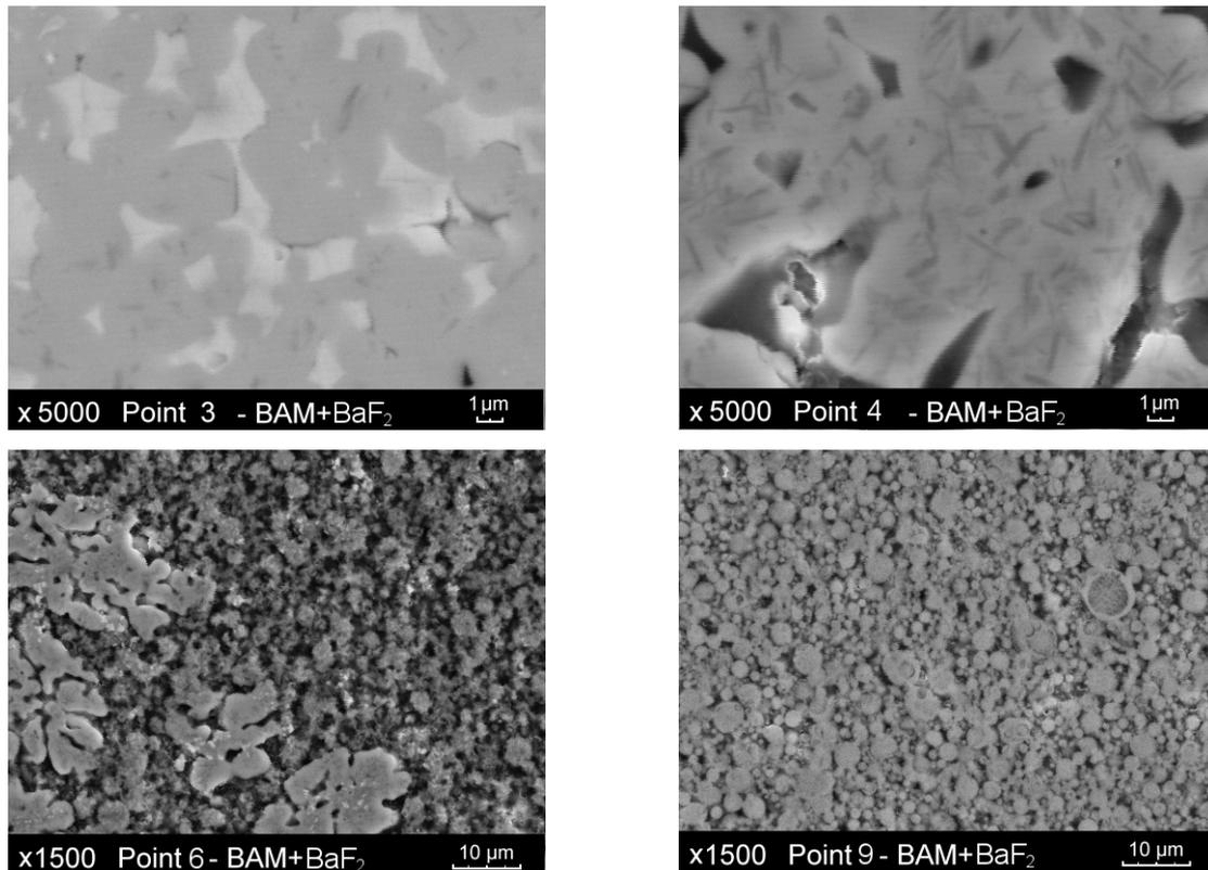
Fig. V.11. Microstructure du comprimé de BAM, dans lequel du  $BaF_2$  a pénétré. Les micrographies ont été prises au niveau des points 3, 4, 6 et 9
