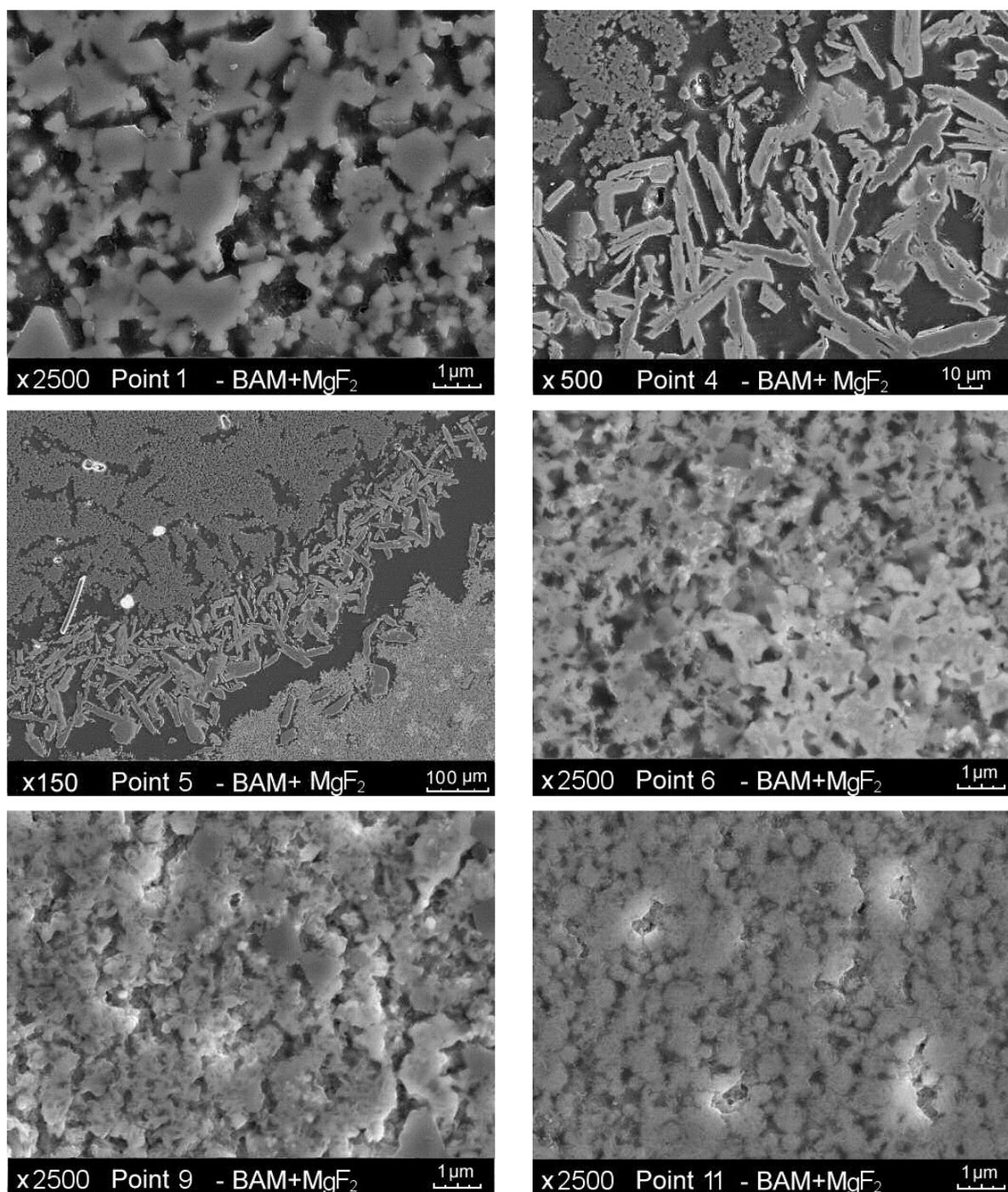
Fig. V.17. Microstructure du comprimé de BAM, dans lequel du MgF<sub>2</sub> a pénétré. Les micrographies ont été prises au niveau des points 1, 4, 5, 6, 9 et 11
