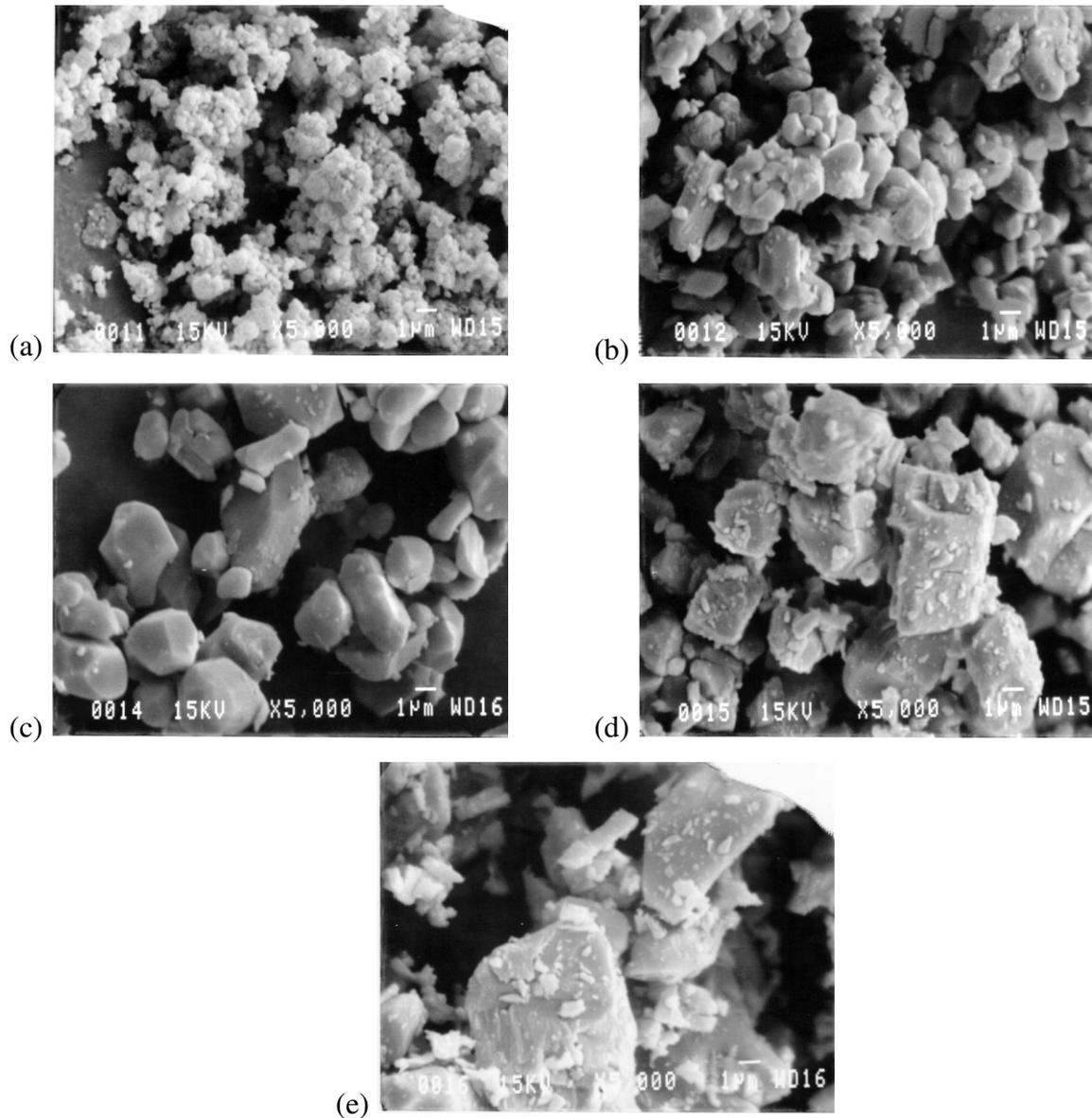
Fig. I.32. Evolution de la morphologie du phosphate de lanthane en fonction de la quantité de  $\text{Li}_2\text{CO}_3$  introduite : (a) 0%, (b) 0,5%, (c) 1%, (d) 2% et (e) 3% de  $\text{Li}_2\text{CO}_3$
