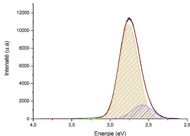
Fig. III.6. Exemple de modélisation d'un spectre de fluorescence par trois gaussiennes
