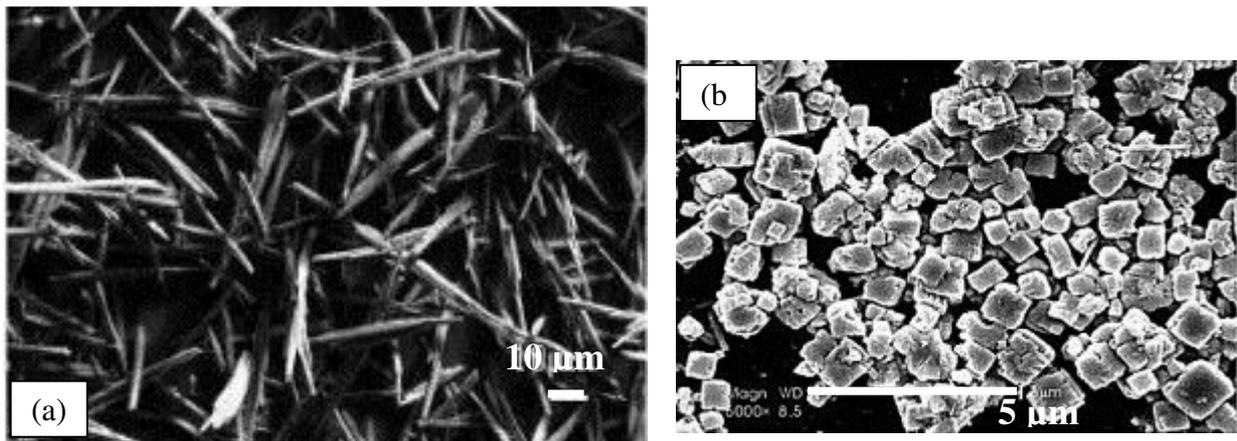
Fig. I.17. Images MEB d'aiguilles de diamètre nanométrique d' $\text{Y}_2\text{O}_3:\text{Eu}$  [I31] (a) et de poudre de  $\text{BaBeF}_4:\text{Eu,Tb}$  [I32] (b)
