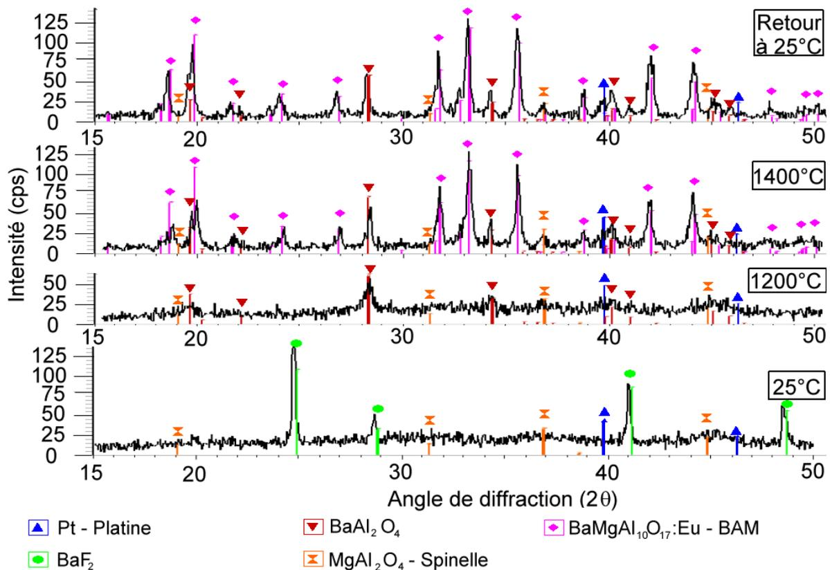
Fig. III.19. Composition de la poudre de précurseur précalcinée à  $900^\circ C$  + 5% volumique de  $BaF_2$ , à différentes températures pendant le traitement thermique
