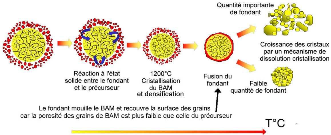
Le fondant a une température de fusion supérieure à la température de cristallisation du BAM et mouille le BAM pendant sa formation (type  $\text{MgF}_2$ ,  $\text{AlF}_3$ )
