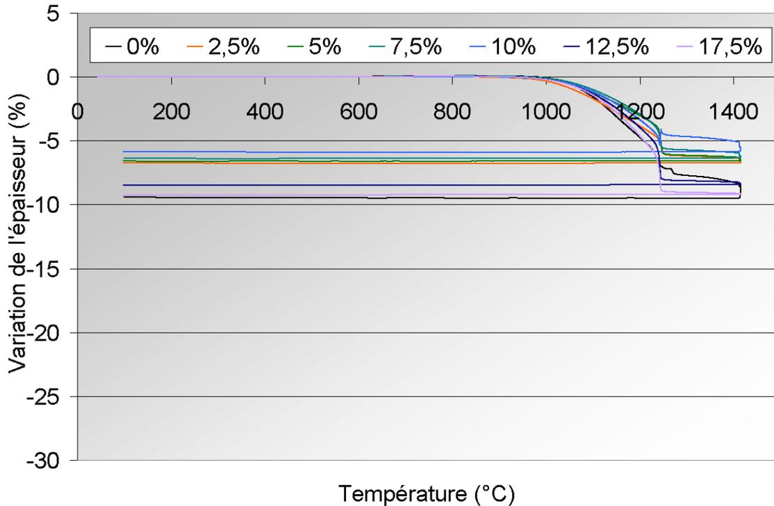
Fig. A9. Evolution des courbes dilatométrique du BAM précalciné à 900°C en fonction de la quantité de BaCl<sub>2</sub> ajouté
