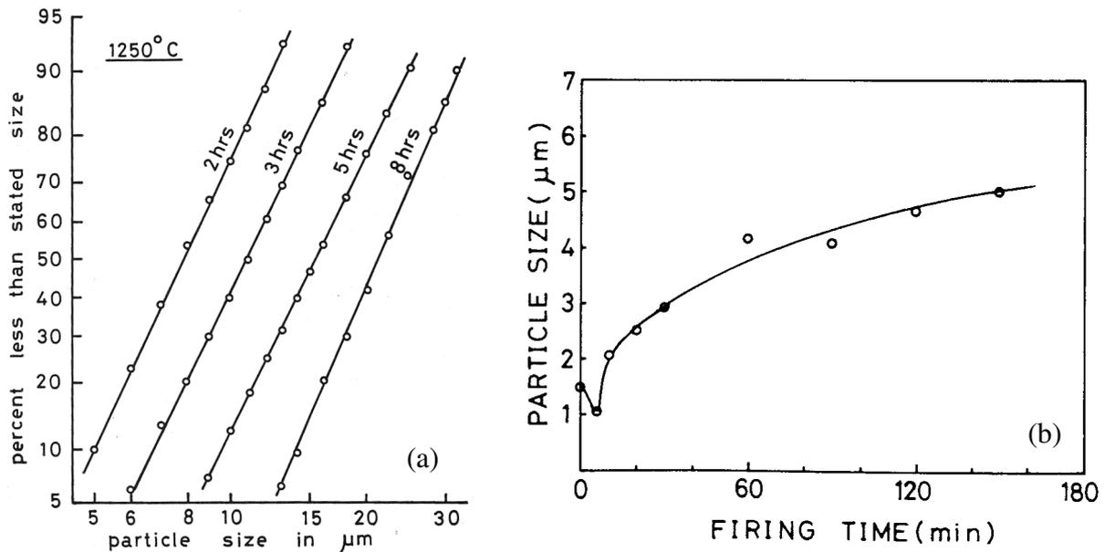
Fig. I.23. (a) Distribution granulométrique d' $Y_2O_2S:Eu$  calciné à  $1250^\circ C$  en fonction de la durée du palier [I41] et (b), taille moyenne des particules d' $Y_2O_2S:Eu$  calciné à  $1180^\circ C$  en fonction de la durée du palier [I39]
