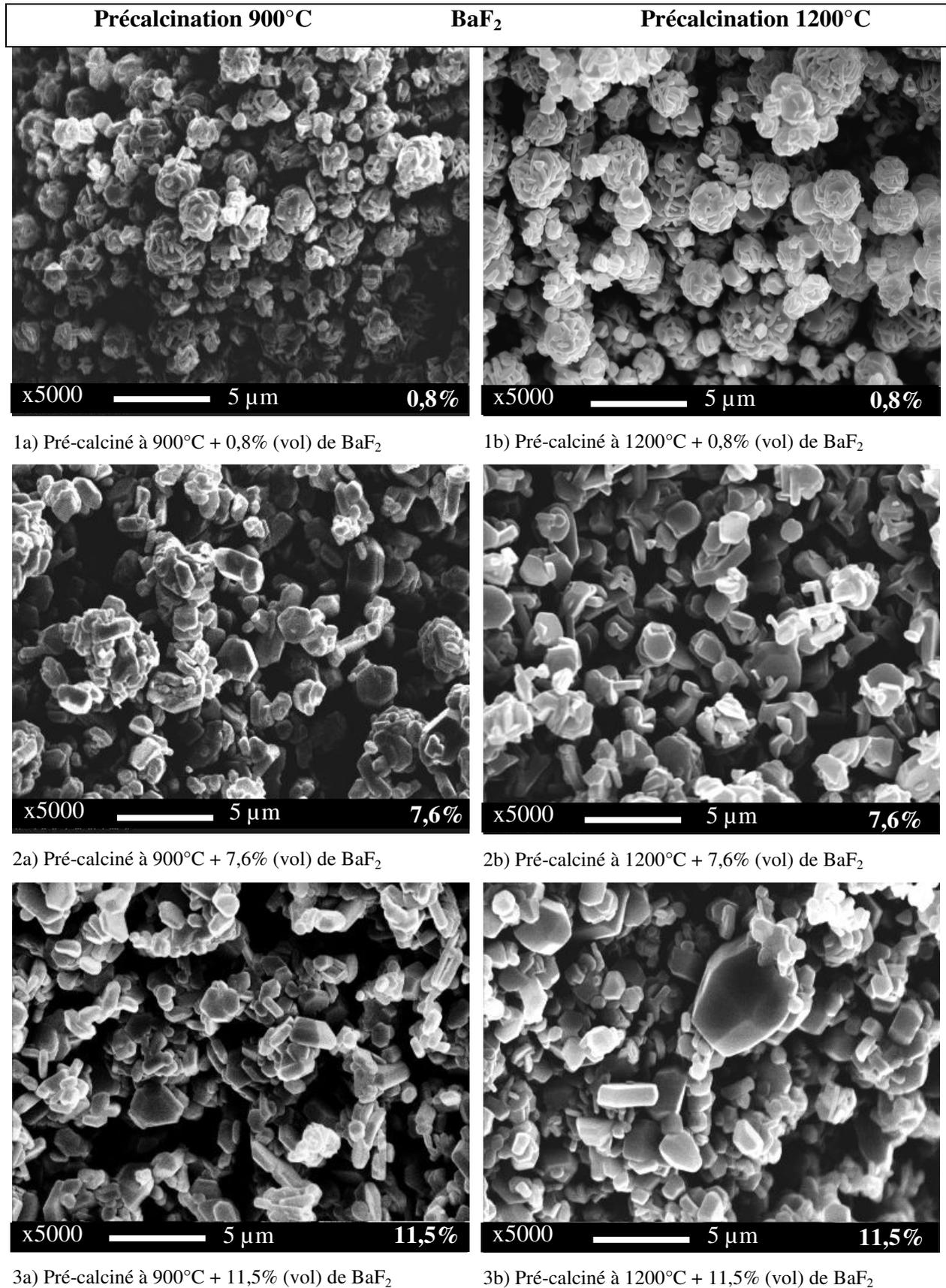
Fig. IV.13. Micrographies de BAM avec ajout de BaF<sub>2</sub>, pré-traité à 900 (figures a) ou 1200°C (figures b), puis calciné à 1400°C sous argon pendant 1 h.
