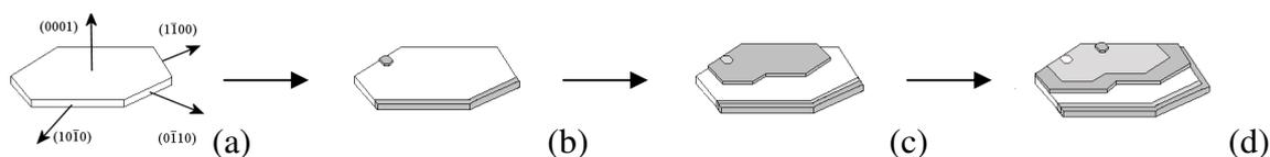
Fig. IV.12. Modèle supposé de la croissance des grains de BAM en présence d'un fondant (LiF,  $\text{Li}_2\text{B}_4\text{O}_7$ ,  $\text{AlF}_3$  ou  $\text{MgF}_2$ ), lors de sa calcination à  $1400^\circ\text{C}$  suite un pré-traitement à  $900^\circ\text{C}$ , en gris foncé, portion du cristal nouvellement formé, en gris clair, portion du cristal formé à l'étape précédente.
