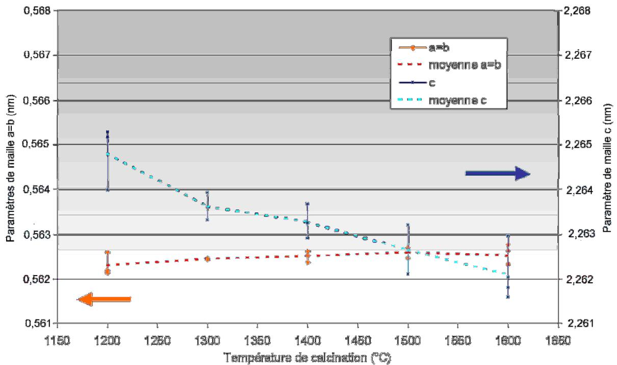
Fig. III.4. Evolution des paramètres de maille du BAM en fonction de la température de calcination
