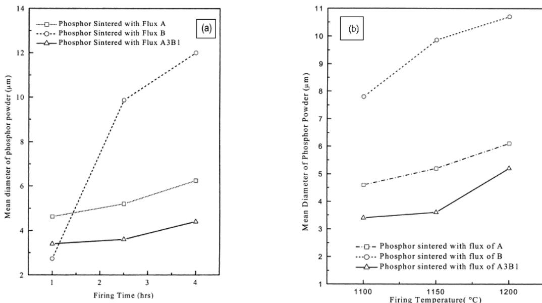
Fig. I.24. Influence de la durée du palier (a) et de la température de calcination (b) sur le diamètre moyen des particules d' $Y_2O_2S$  formées [I42]
