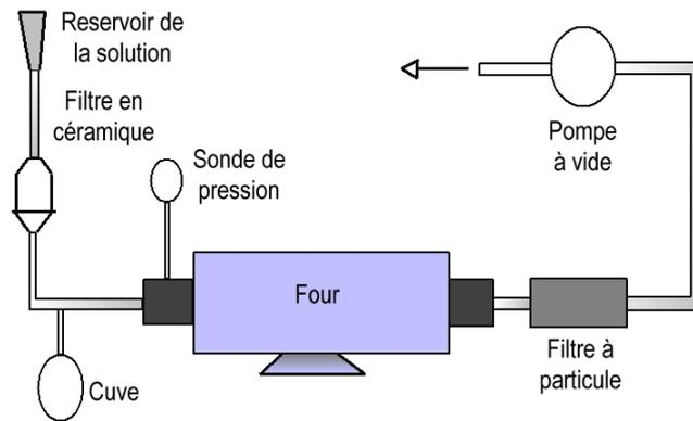
Fig. I.14. Schéma d'un appareil de « spray-pyrolysis »
