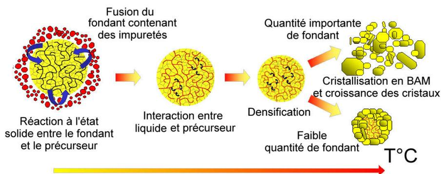
Le fondant a une température de fusion supérieure à la température de cristallisation du BAM et mouille le BAM après sa formation (type  $\text{BaF}_2$ ,  $\text{CaF}_2$ )
