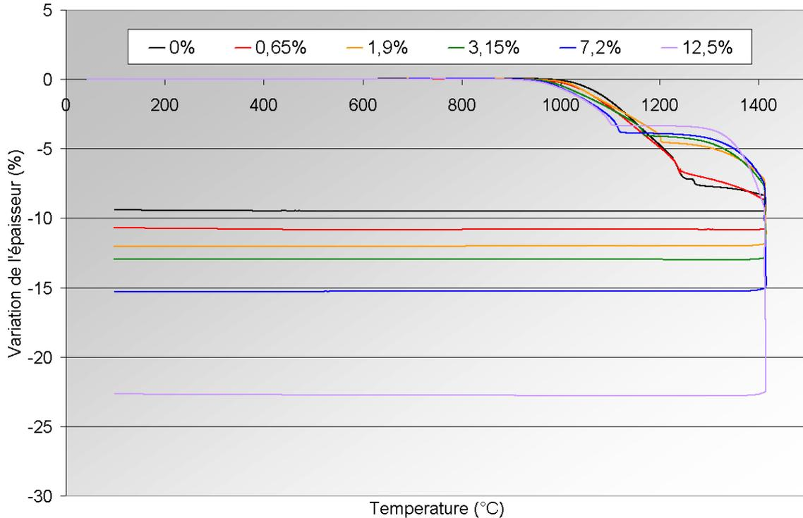
Fig. A15. Evolution des courbes dilatométriques du BAM précalciné à 900°C en fonction de la quantité de CaF<sub>2</sub> ajouté
