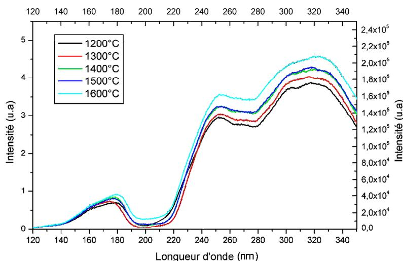
Fig. II.12. Spectres d'excitation du BAM calciné sous  $\text{Ar}/\text{H}_2$  pendant 2h à différentes températures de calcination
