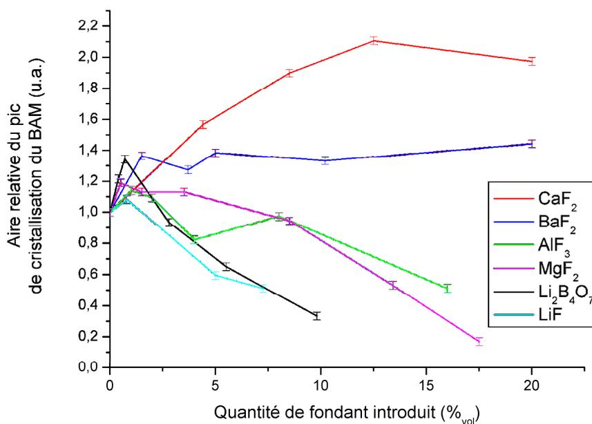
Fig. IV.30. Evolution de l'aire du pic de cristallisation du BAM mesurée en ATD, en fonction de la quantité de fondant ajouté
