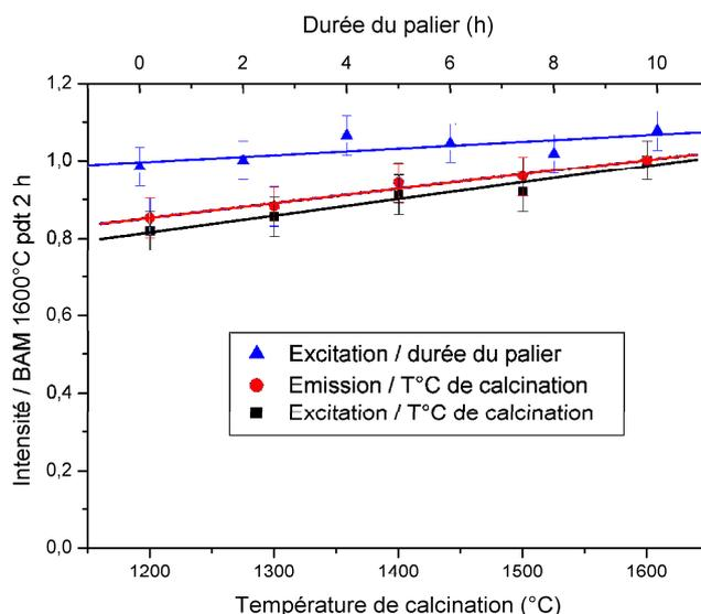
Fig. II.13. Valeurs intégrées des spectres d'excitation du BAM calciné sous  $\text{Ar}/\text{H}_2$ , en noir, pendant 2h en fonction de la température de calcination, en bleu à 1600°C en fonction de la durée du palier et en rouge du spectre d'émission du BAM calciné sous  $\text{Ar}/\text{H}_2$  pendant 2h en fonction de la température de calcination, normés sur les spectres d'excitation et d'émission, de l'échantillon de BAM calciné sous  $\text{Ar}/\text{H}_2$  à 1600°C pendant 2 h.
