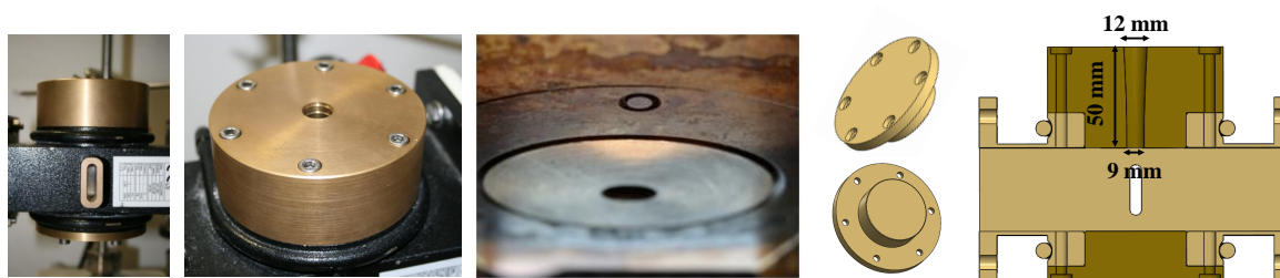
Figure C.18 – Photographies et représentation 3D de la cavité équipée des bouchons en laiton
